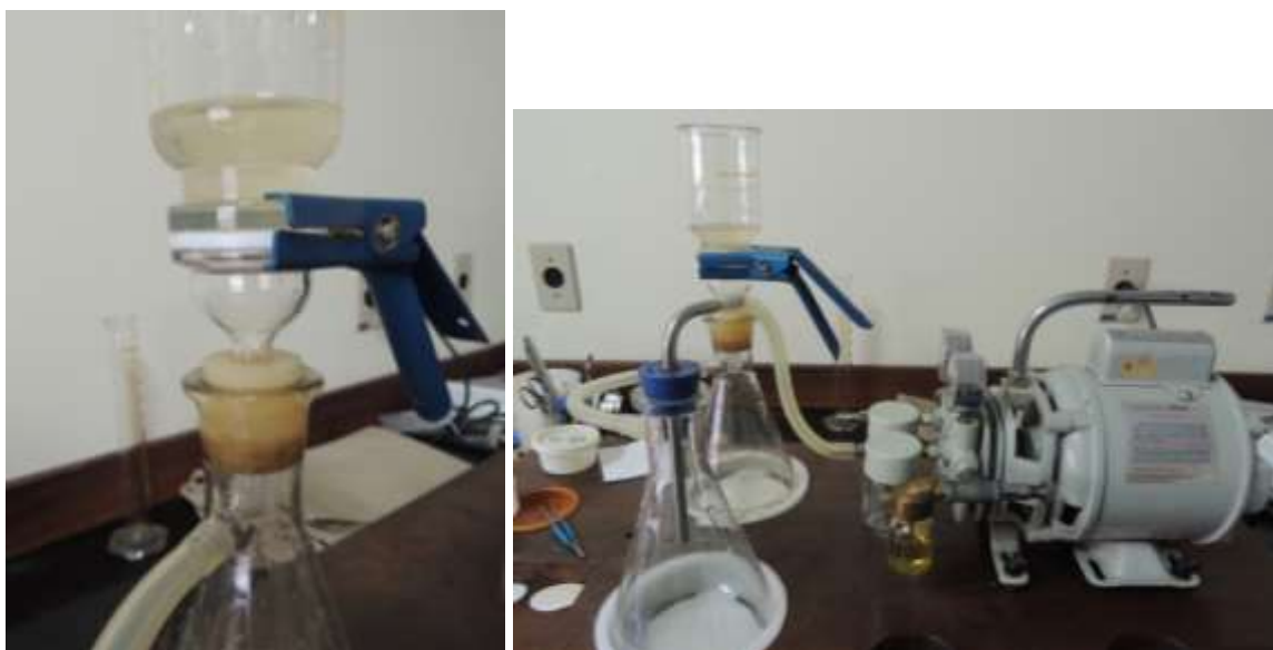
Figura 21 - Equipamento para filtração sob pressão.
