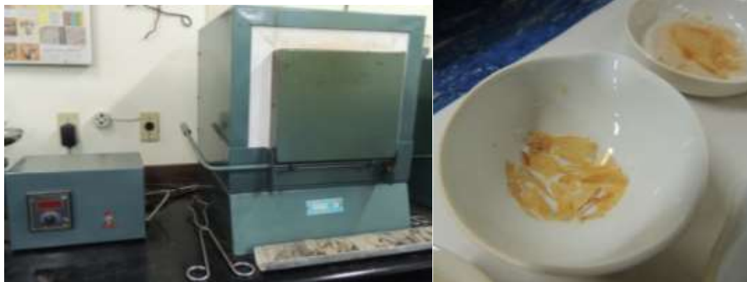
Figura 22 - Processo de queima em duas etapas, do filtro de acetato e do material orgânico em suspensão, primeiro por combustão e em seguida em mufla.
