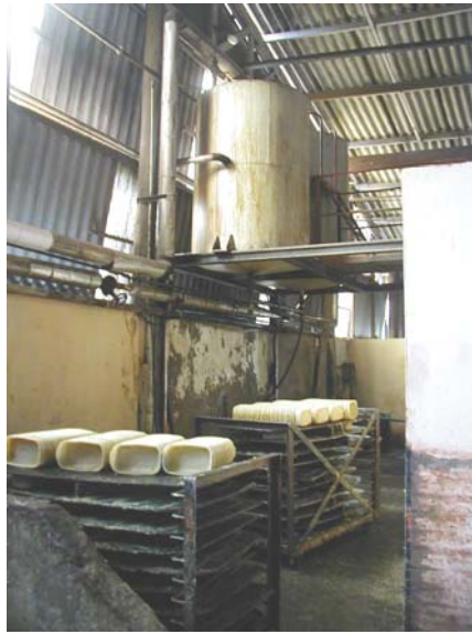
Figura 3.4: Tanques de sebo fundido e recipientes utilizados no resfriamento
