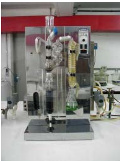
Figura A.2: Foto do destilador utilizado para determinação de substância dérmica
