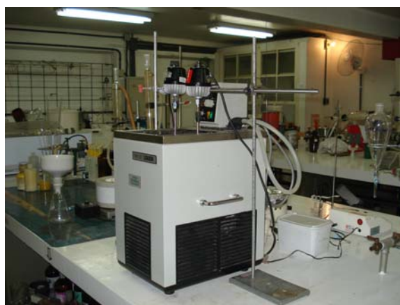
Figura 3.11: Equipamento utilizado na etapa cristalização no fracionamento do sebo bovino
