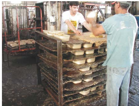
Figura 3.5: Acondicionamento do sebo cristalizado no meio filtrante
