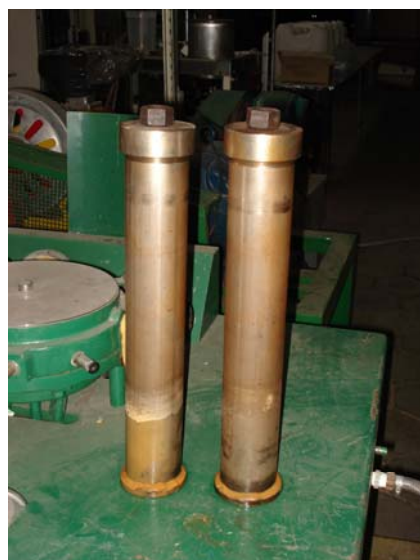
Figura 3.9: Cilindros de inox empregados no isolamento do resíduo no interior do digestor
