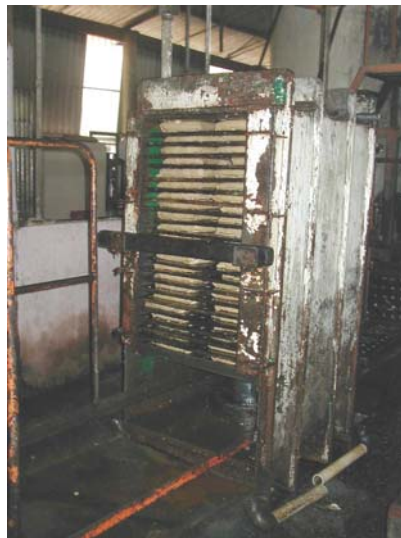
Figura 3.6: Prensa onde são separados os componentes do sebo
