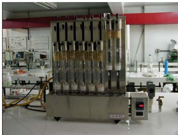
Figura A.1: Conjunto para determinação gordura Tecnal modelo TE-044
