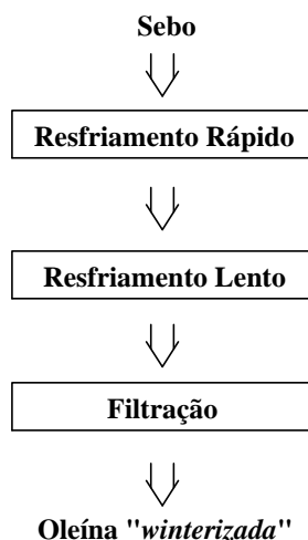
Figura 3.10: Etapas do processo de fracionamento via seca (“winterização”)
