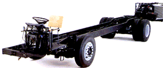
Figura B9: Chassi OH 1621, equipado com motor OM366LA.
