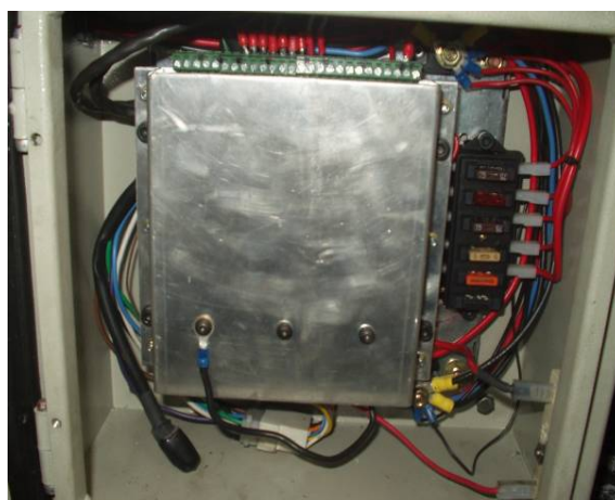
Figura B21: Unidade de Comando Eletrônico, responsável pelo controle de combustível e da ignição.
