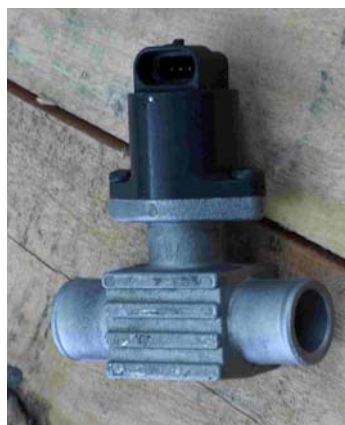
Figura B18: Válvula dosadora (motor-de-passo) instalada.
