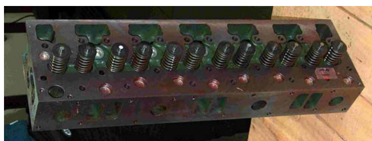
Figura B27: Cabeçote do motor Otto, prevendo a instalação de velas de ignição e mecanismo de catraca para abertura das válvulas, uniformizando o desgaste.
