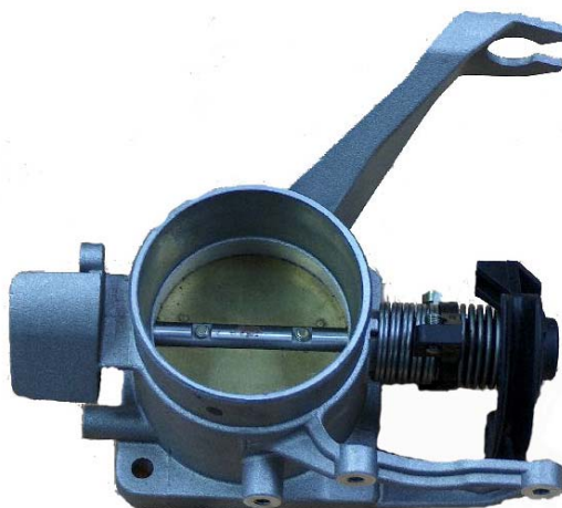
Figura B20: Válvula borboleta instalada no coletor de admissão.
