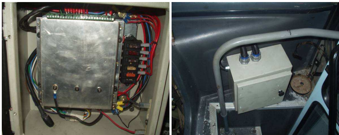
Figura 4.9: Unidade de Comando Eletrônico montada em uma caixa de alumínio (a esquerda) e sua disposição no painel frontal do GASBUS (a direita).
