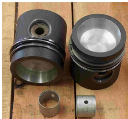
Figura B24: Pistões utilizados na conversão do motor sem a pré-câmara de combustão presente nos pistões do motor diesel original.
