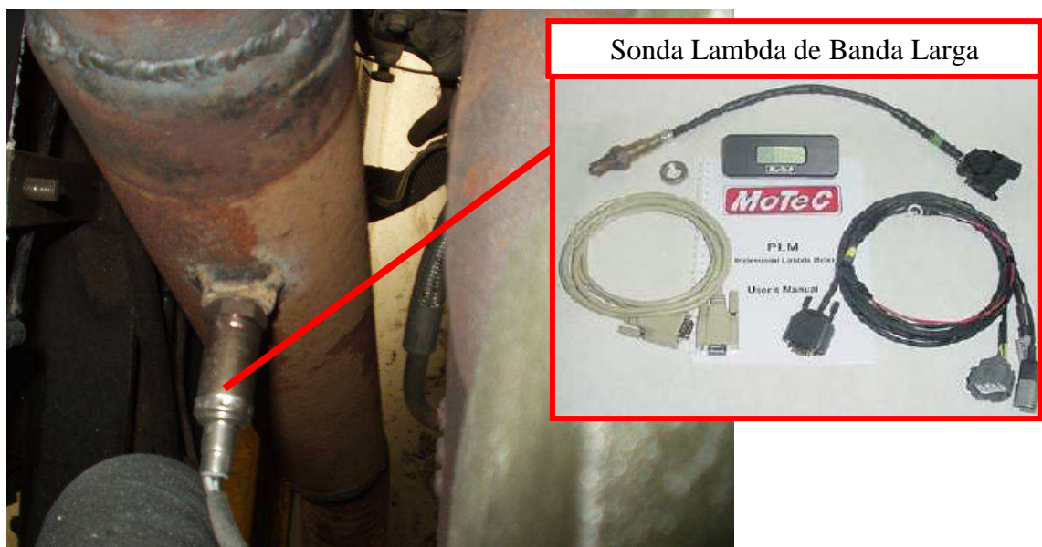
Figura 4.22: Sonda Lambda de Banda Larga instalada no tubo de escape.
