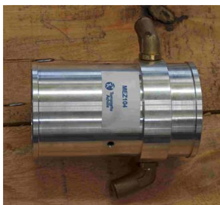
Figura B19: Mesclador de gás instalado entre o intercooler e o coletor de entrada.
