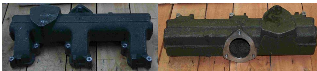
Figura B26: Coletor de escape (esquerda) e coletor de admissão (direita) componentes do kit de conversão.
