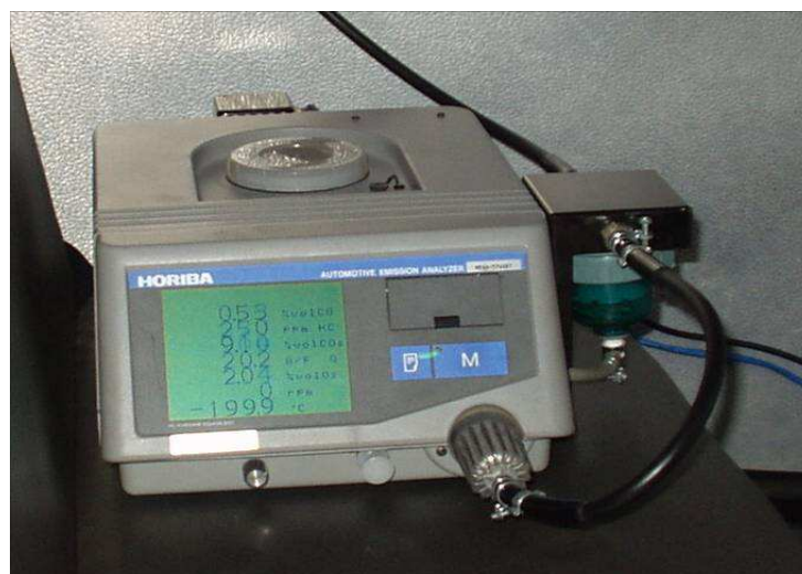
Figura 4.24: Analisador de gases MEXA 574GE, fabricado pela Horiba, instalado no GASBUS durante testes de campo.
