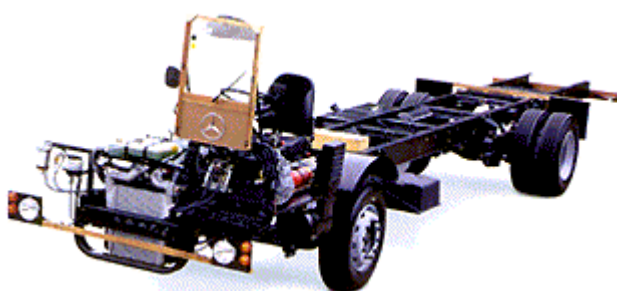
Figura B8: Chassi OF 1721, motorização dianteira, motor OM366LA, utilizado no ônibus original diesel.
