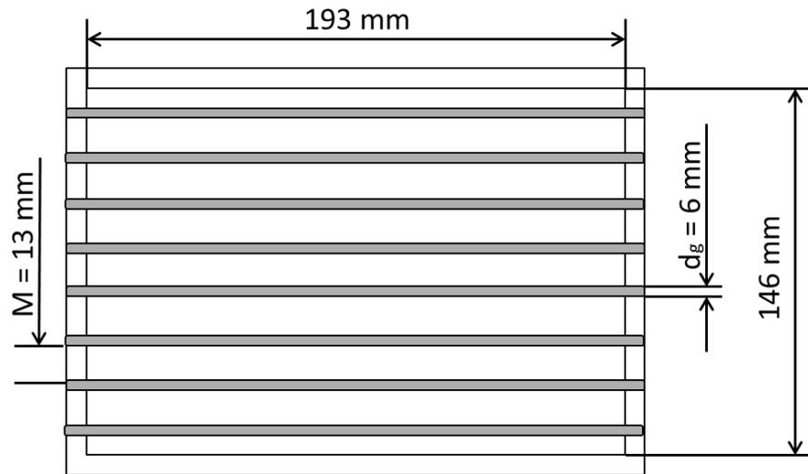
Figura 3.3 – Representação da geometria da grade promotora de turbulência.
