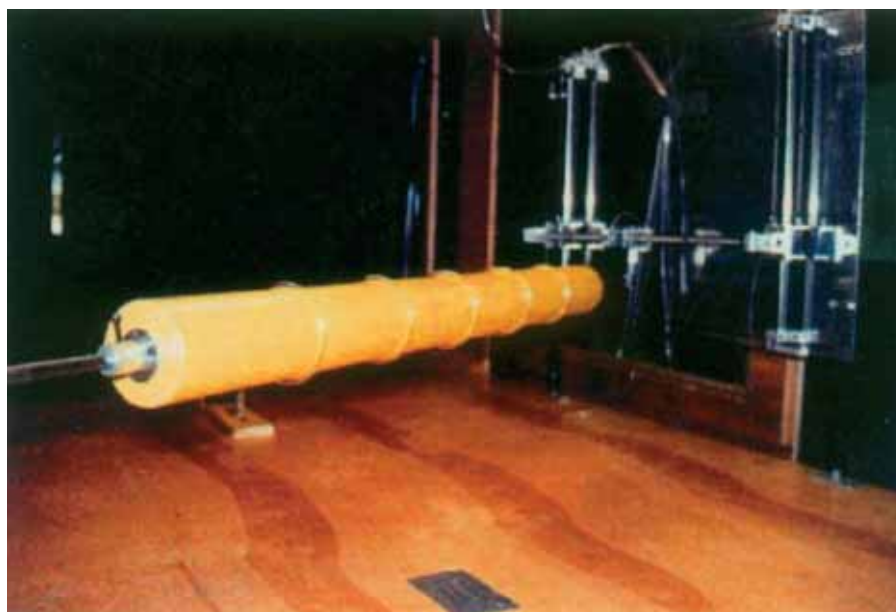
Figura 3.31 – Cabo com anéis circulares como dispositivo mitigador de vibrações (Phelan et al., 2006).
