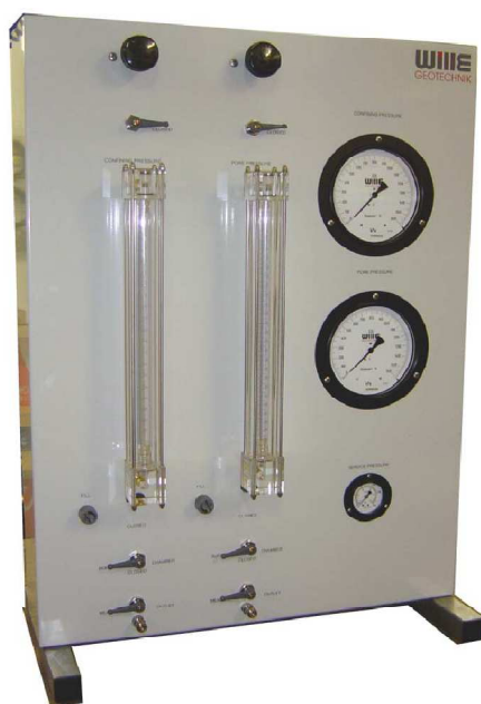
Figura 4.7: Painel de aplicação manual de pressões
