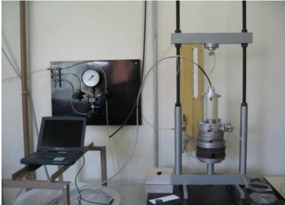
Foto 4.17: Equipamento utilizado para a calibração dos transdutores elétricos
