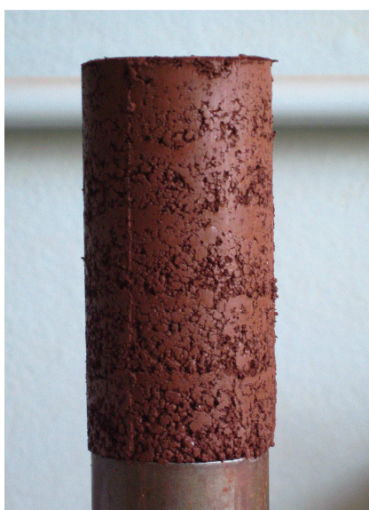
Foto 5.3: Corpo de prova remoldado a partir da técnica moist-tamping em 5 camadas
