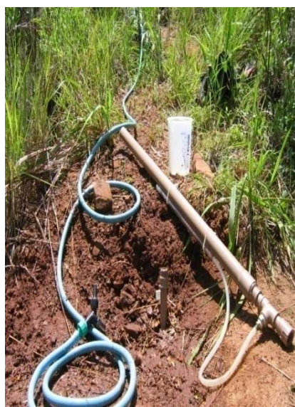
Foto 4.16: Piezômetro instalado na cota 347 m da encosta para a realização do ensaio
