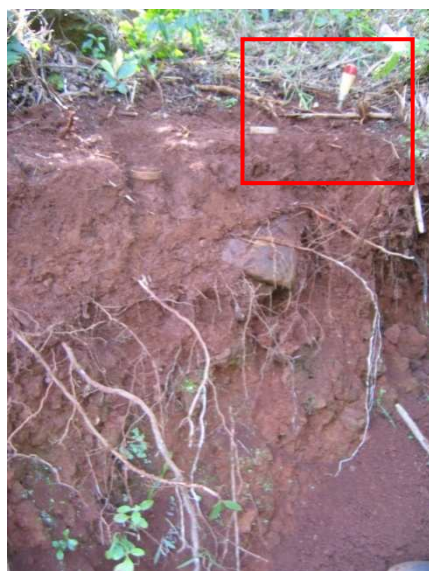
Foto 4.2: Ponto de coleta de amostras indeformadas para a realização dos ensaios de cisalhamento direto (cota 360 m)
