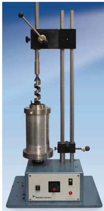
Figura 4.4: Equipamento drilling utilizado na perfuração dos corpos de prova
