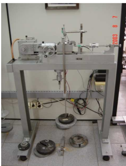
Foto 4.4: Equipamento para ensaio de cisalhamento direto instrumentado
