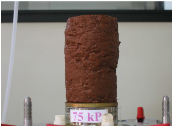
Foto 5.1: Corpo de prova indeformado do ensaio triaxial CID ensaiado com \sigma'_c=75 kPa
