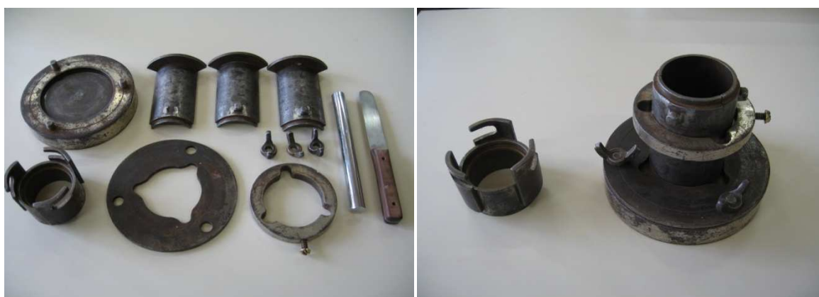
(a) (b) Foto 4.9: Molde tripartido utilizado para moldagem dos corpos de prova remoldados para os ensaios triaxiais: (a) molde desmontado e (b) molde montado
