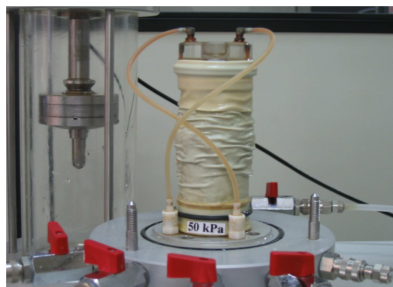
Foto 5.4: Corpo de prova remoldado do ensaio triaxial CIU ensaiado com \sigma'_c=50 kPa
