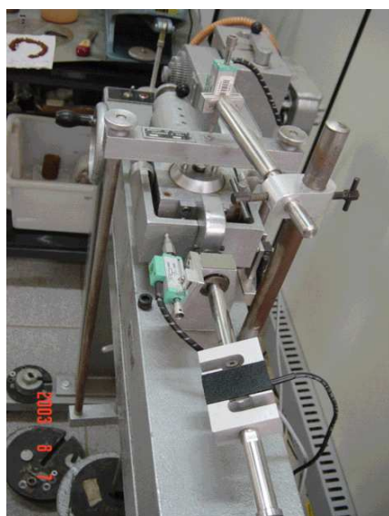
Foto 4.5: Detalhe do equipamento para ensaio de cisalhamento direto instrumentado
