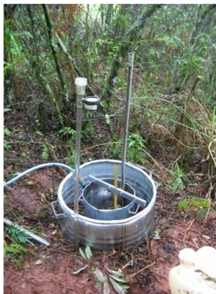
Foto 4.20: Cilindros e tensiômetros instalados na encosta para a realização do ensaio (cota 365 m)
