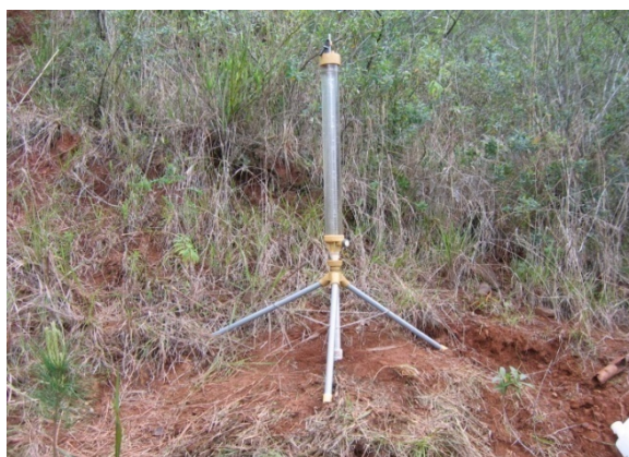
Foto 4.15: Permeâmetro de Guelph instalado na cota 350 m da encosta em estudo pronto para a realização do ensaio
