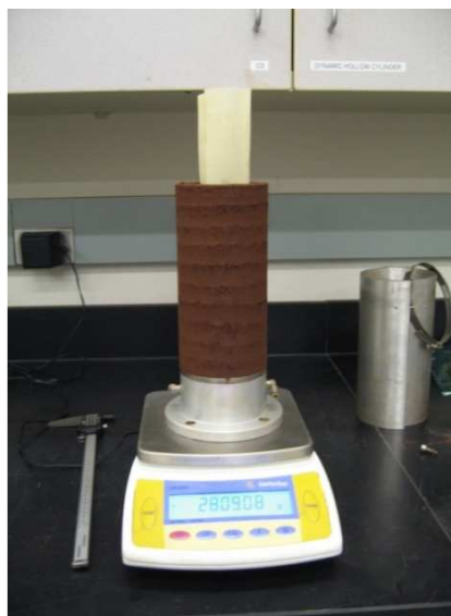
Foto 5.5: Corpo de prova preparado em 10 camadas com a técnica de moldagem moist-tamping
