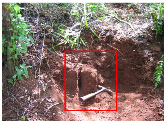
Foto 4.3: Ponto de coleta de amostras indeformadas para a realização dos ensaios triaxiais e dos ensaios de condutividade hidráulica (cota 365 m)
