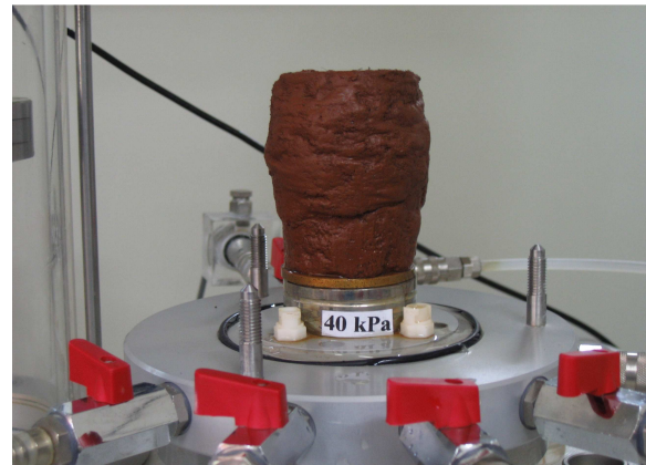
Foto 5.2: Corpo de prova remoldado do ensaio triaxial CIU ensaiado com \sigma'_c=40 kPa
