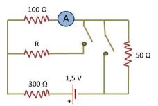
F6 — Determine o valor da corrente que passa por cada um dos resistores, a potência fornecida por cada uma das fontes de tensão e a potência dissipada por cada um dos resistores. Faça o balanço energético do circuito.
