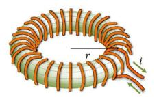
G30 – A figura ao lado mostra um toroide, que consiste num solenoide fechado em forma de anel. (a) Considerando a simetria, explique qual deve ser o formato do campo magnético no interior desse toroide. (b) Considere o
