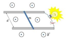
passa uma corrente  $i=9,13\ mA$ . O conjunto está numa região onde existe um campo magnético uniforme  $B=56,3\ mT$ . Qual a velocidade da barra  $61,1\ ms$  depois? Em que direção ela se move?
