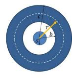
G21 – A figura ao lado mostra um cabo coaxial de raios a, b e c. Correntes opostas de igual magnitude estão distribuídas nos dois condutores. Derive uma expressão para calcular o campo magnético B(r) na região (a) r < a, (b) a < r < b, (c) b < r < c e (d) r > c.
