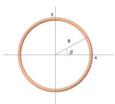
B7 – Calcule a magnitude, direção e sentido do campo  $\vec{E}$  no centro de um anel de raio R carregado, sendo que a distribuição de cargas no anel varia como  $\lambda(\beta) = \lambda_0 \ sen \ \beta$ .
