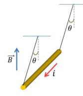
G8 – Uma barra de metal com densidade de massa  $\lambda$  (massa por unidade de comprimento) apresenta uma corrente i. A barra está suspensa por dois fios num campo magnético uniforme vertical como mostra a figura ao lado. No equilíbrio, os fios fazem um ângulo  $\theta$  com a vertical. Qual a magnitude do campo magnético?
