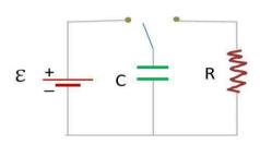
resistor de resistência R e um capacitor de capacitância C é a forma mais simples de circuito RC (figura abaixo). A energia elétrica armazenada no campo elétrico do capacitor é convertida em outras formas de energia
