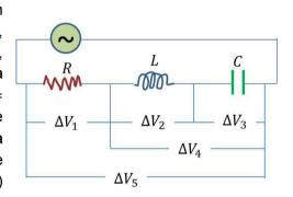
J5 – Num circuito RLC,  $L=0.28\,H$  e  $C=4\,\mu F$ . A fonte fornece uma voltagem com amplitude de  $120\,V$ . Qual é a frequência angular de ressonância do circuito? (b) Quando a fonte opera na frequência angular de ressonância, a amplitude da corrente no circuito é  $1.7\,A$ . Qual a resistência do resistor? (c) Na frequência angular de ressonância, quais são as voltagens de pico no indutor, capacitor e resistor?
