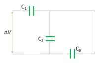
lado onde  $C_1=10~\mu F$ ,  $C_2=5~\mu F$  e  $C_3=4~\mu F$ . Se o capacitor 3 é substituído por um fio condutor, qual é o aumento na carga do capacitor 1? Qual é o aumento na diferença de potencial entre as placas do capacitor 1?
