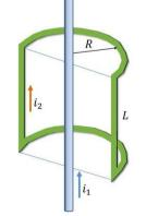
G25 – Um fio condutor muito longo por onde passa uma corrente  $i_1$  está parcialmente envolto por um loop por onde passa uma corrente  $i_2$  (figura ao lado). O loop fio foi moldado num formato semicilíndrico de raio R e o comprimento L. O fio condutor passa pelo eixo do loop. Calcule a força magnética exercida sobre o loop.
