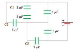
E5 - Na figura ao lado, a ddp da bateria é  $10~V,~C_1=10~\mu F~,C_2=C_3=2C_1.$  A chave é movida para a esquerda e somente depois que
