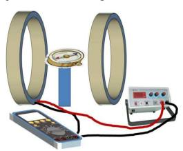
igual a *R*. Com a bobina de Helmholtz é possível produzir um campo magnético com orientação bem determinada e módulo que pode ser ajustado variando-se a intensidade da corrente que passa pela bobina.
