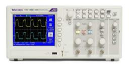
em função do tempo. A ordenada (eixo vertical) é a ddp entre dois pontos (ou a tensão de um ponto em relação à Terra) e a abscissa é o tempo. Ou seja, a tela de um osciloscópio é um gráfico de uma função da tensão contra o tempo:  $V(t) \times t$ . Ele é um instrumento próprio para observar variações rápidas de tensões ao longo do tempo, informação essa que não pode ser obtida por um multiteste comum.
