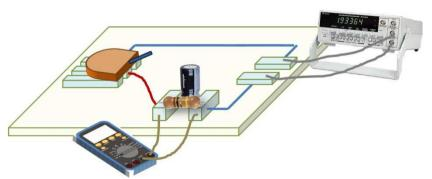
imediatamente. Quando a chave for posicionada para a esquerda, o capacitor vai descarregar diretamente no resistor. A chave seletora e o cronômetro devem ser acionados ao mesmo tempo (de preferência
