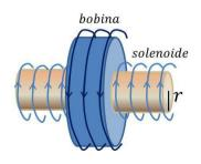
l4 – A fem autoinduzida num solenoide de indutância L varia no tempo conforme  $\mathcal{E}(t)=\mathcal{E}_0e^{-kt}$ . Levando em consideração que a carga é finita, determine a carga total que passa pelo solenoide (que atravessa um determinado ponto no fio que compõe o solenoide).
