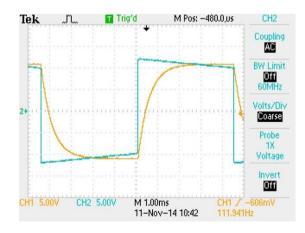
Determine a constante de tempo do circuito para três valores diferentes de resistência e / ou capacitância. Os resultados mostrados na tela do osciloscópio podem ser salvos numa USB para depois
