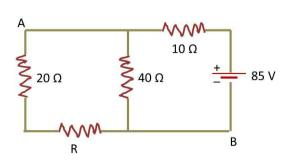
F4 – No circuito ao lado, a potência dissipada no resistor R é 20 *W*. Qual o valor de R? Qual a ddp entre os pontos A e B?
