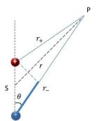
D3 – A figura ao lado mostra um dipolo elétrico de momento dipolar  $|\vec{p}|=Sq$ . Mostre que para  $r\gg S$ , o potencial elétrico no ponto P é dado por :
