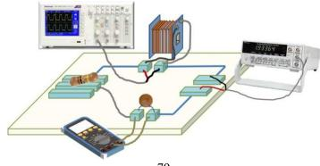
Ajuste a fonte para a frequência de ~500 Hz. Meça a intensidade da corrente eficaz, as tensões eficazes sobre o indutor, o capacitor e o resistor. Calcule a reatância indutiva (razão da tensão eficaz no indutor e da intensidade da corrente eficaz). Calcule também a reatância capacitiva. A partir das reatâncias, calcule a indutância e a capacitância.
