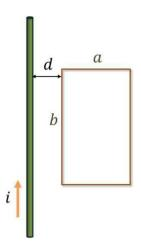
H2 – (a) Calcule o fluxo magnético através do retângulo mostrado na figura ao lado em função de a, b, d e i. (b) Avalie o resultado encontrado para a = 5 cm, b = 10 cm, d = 2 cm e i = 20 A.
