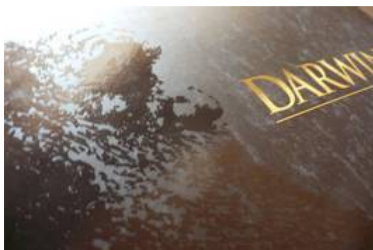
Exemplo de aplicação de verniz localizado brilhante e de hot-stamping sobre laminação fosca
