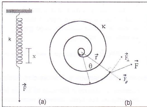
Figura 5: (a) Deformação produzida em uma mola comum.
