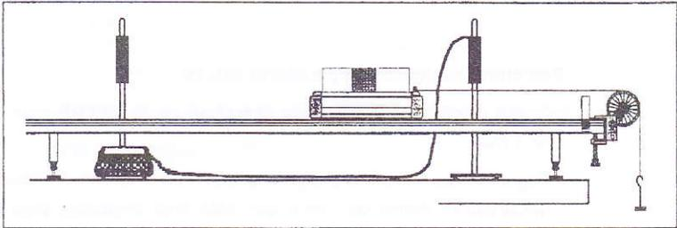
Figura 2: Esquema do dispositivo experimental utilizado na verificação da 2ª lei de Newton.
