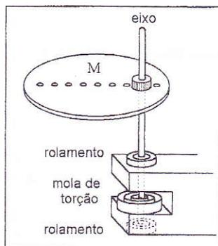
Figura 6: Montagem do experimento.
