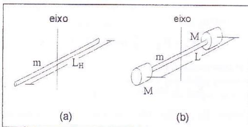
Figura 4: (a) Haste homogênea e (b) haste homogênea com duas massas acopladas.
