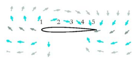
Figura 6. Direção do movimento do ar em torno de uma asa como vista por um observador em terra.
