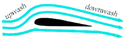
Figura 3. Fluxo de ar verdadeiro pela asa, mostrando o upwash e o downwash.
