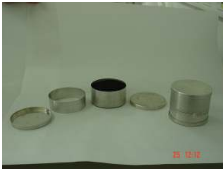
Figura 7 - Detector para estimativas rápidas, pequenos recipientes metálicos ( canisters ) contendo carvão ativado.
