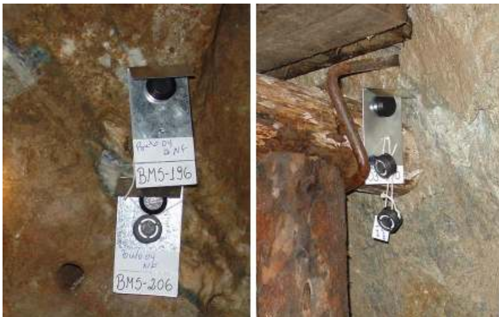
Figura 16 - Detectores instalados, em pontos diferentes. Na esquerda temos dois detectores CR 39 e um Lexan, e na direita um detector CR 39 e dois LEXAN, um é o detector temporizador.
