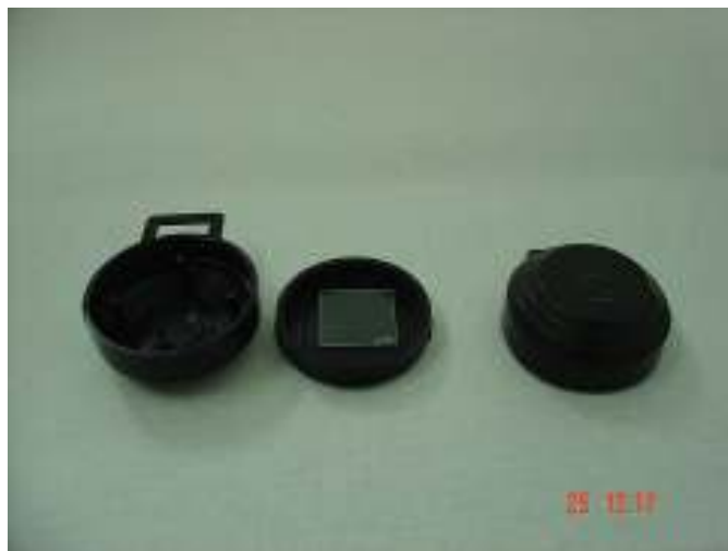
Figura 8 - Detectores tipo traços ( track etch ), que consistem, essencialmente, numa pequena câmara circular, contendo um pedaço de plástico.
