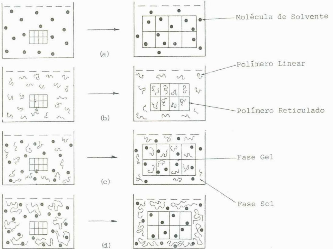
Figura 1 - Intumescimento de amostras reticuladas de polímero em: a) solvente; b) polímero linear com baixo peso molecular; c) solvente + polímero linear com baixo peso molecular; d) solvente + polímero linear com alto peso molecular.
