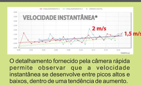
O detalhamento fornecido pela câmera rápida permite observar que a velocidade instantânea se desenvolve entre picos altos e baixos, dentro de uma tendência de aumento.
