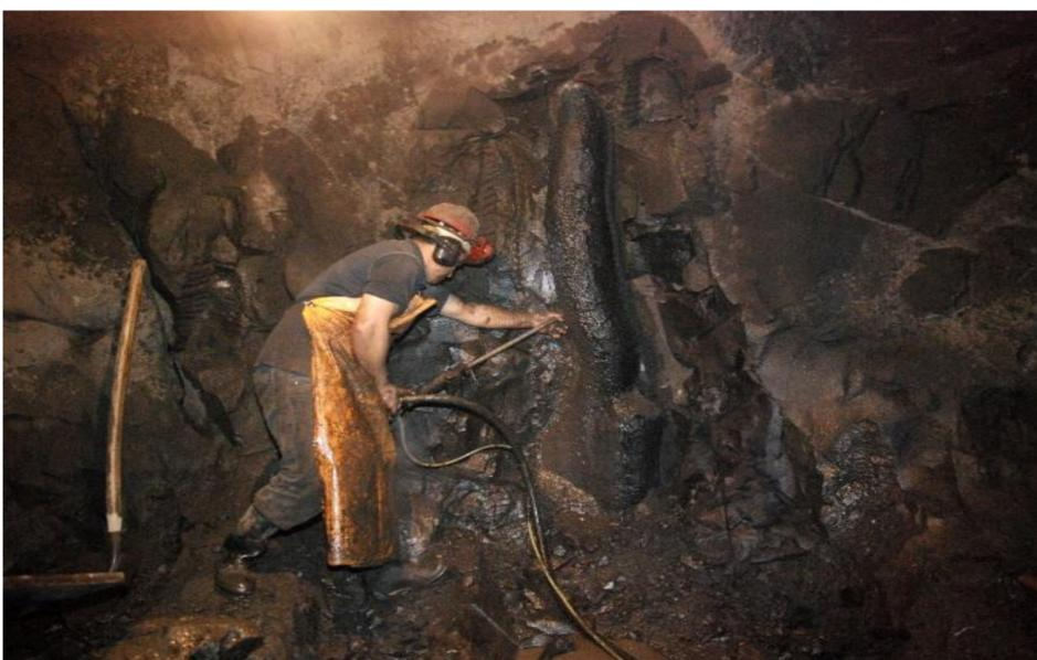
Figura 1. Perfuração da rocha à úmido associada ao uso de EPIs.
