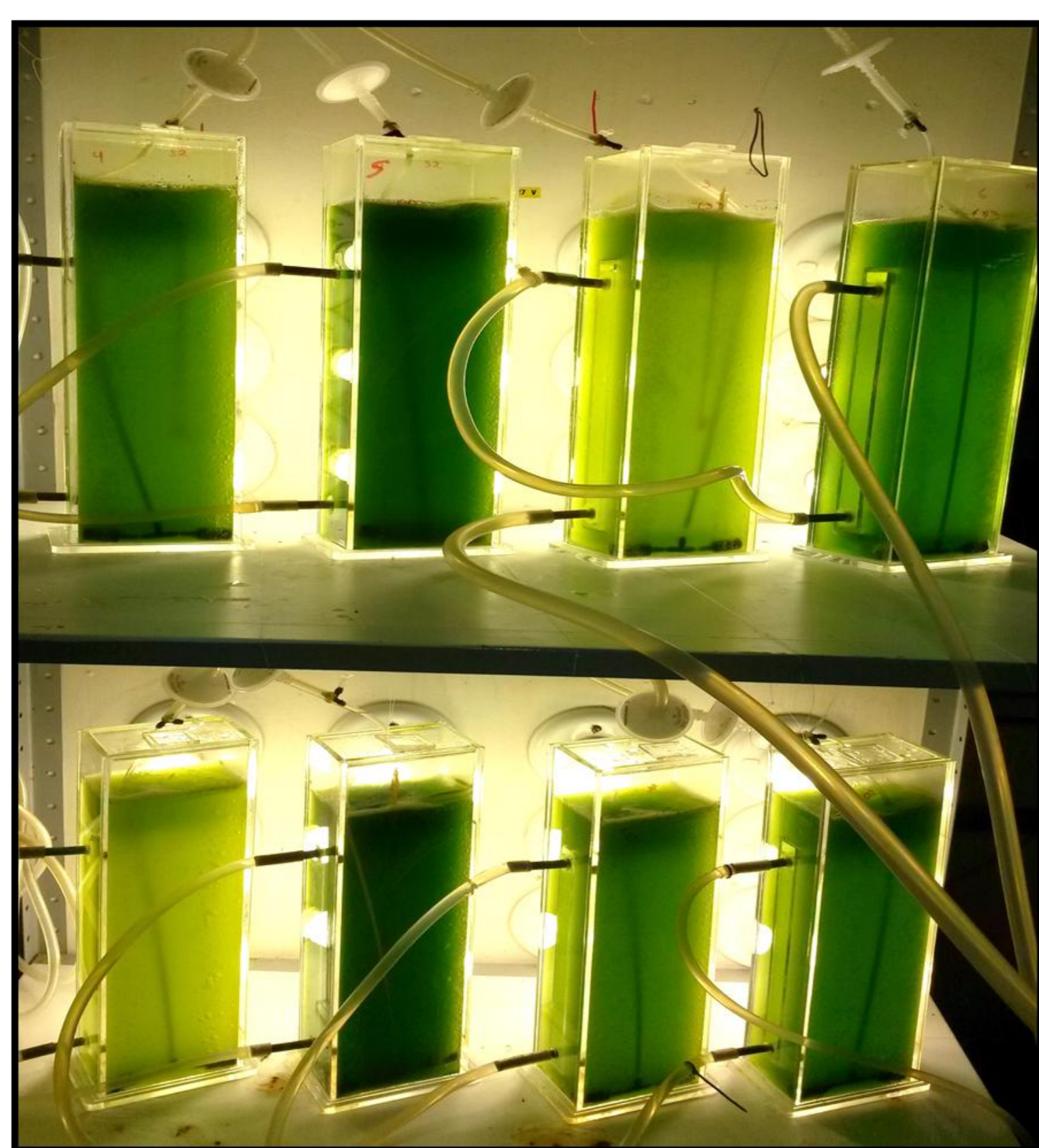
Figura 1. Cultivo da microalga Chlorella sp. em fotobiorreator de placa airlift sob diferentes condições de nitrogênio e temperatura.
