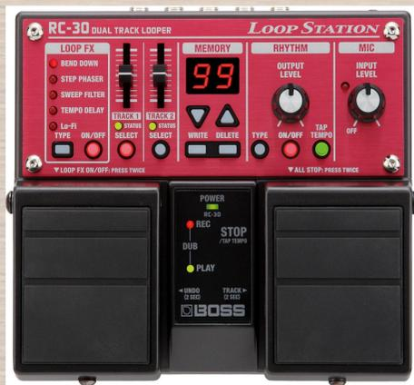
Um pedal de loop de guitarra grava passagens curtas tocadas por um instrumento e joga-os de volta em um loop de repetição. Loops podem ser utilizados em conjunto para criar ritmos e harmonias complexas a partir de camadas de partes mais simples.
