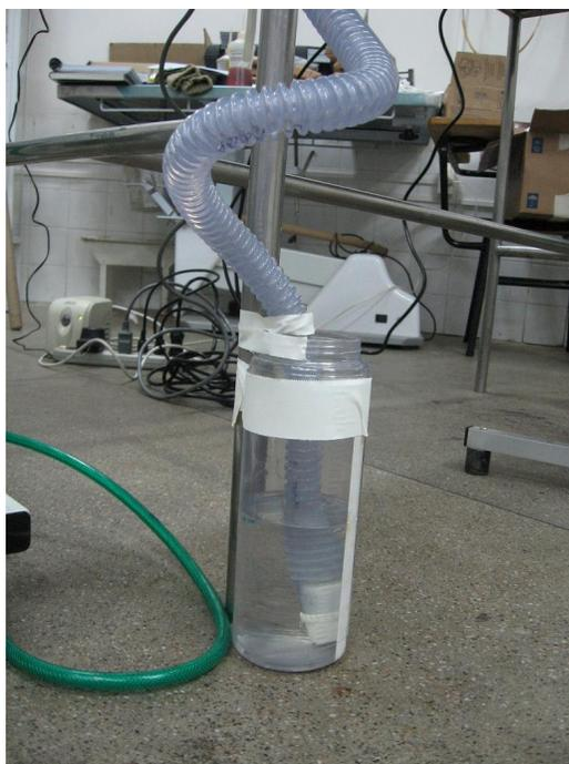
Figura 3: Tubo corrugado imerso em um recipiente contendo uma coluna de 10 cm de água, caracterizando a PEEP.
