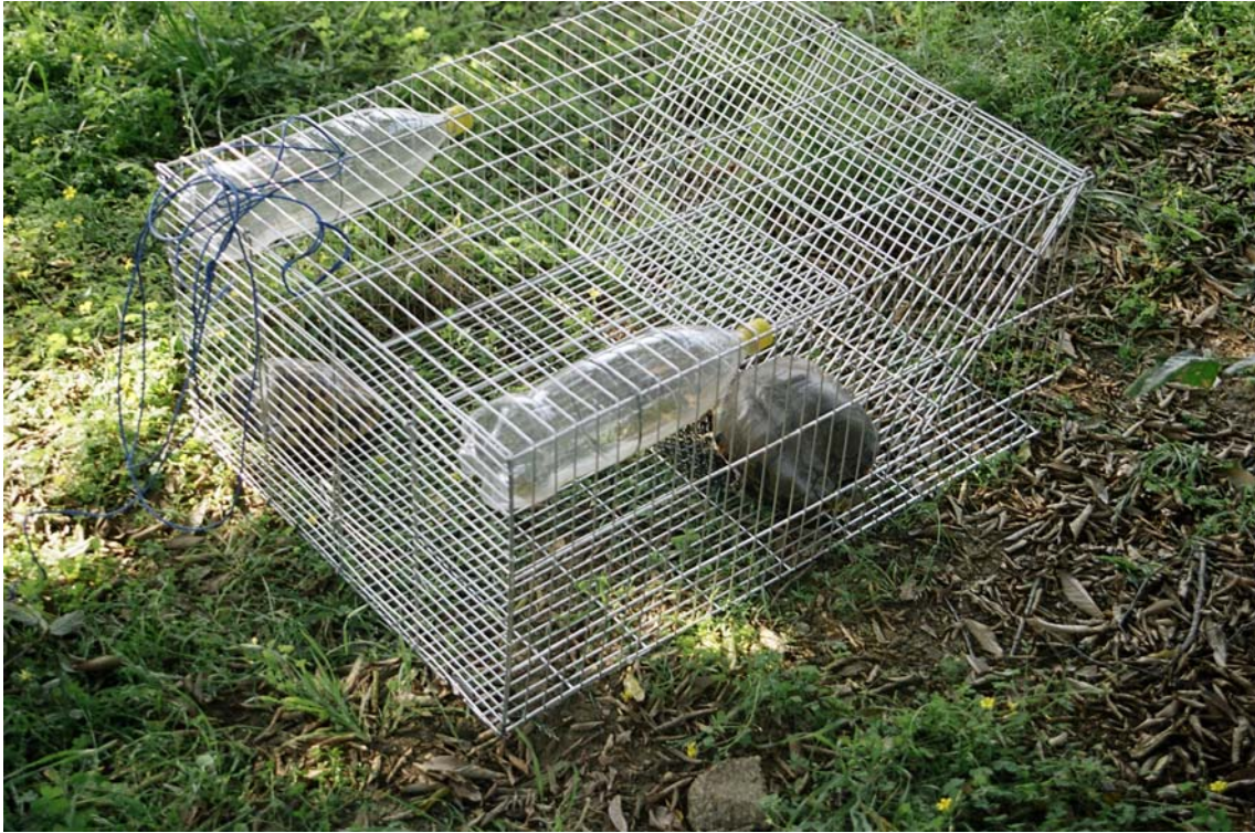
Figura 2.7 – Armadilha iscada de espera confeccionada em arame galvanizado utilizada para captura de quelônios. Observam-se as garrafas plásticas servindo como bóias, evitando-se, assim, o afogamento dos animais apreendidos.
