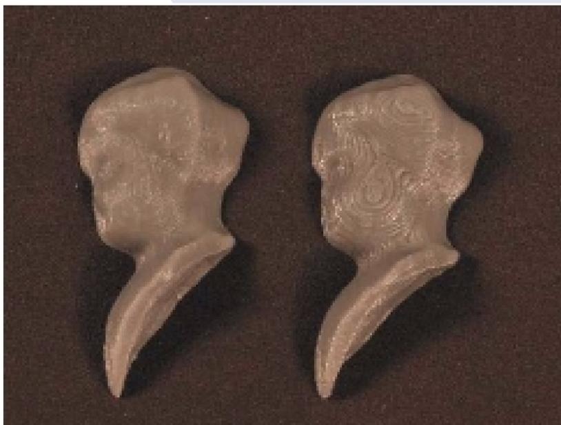
A boneca sofreu corte longitudinal e a impressão em alta qualidade atingiu melhores resultados, a imagem comparou a impressão de alta qualidade e a impressão rápida. Nota-se que a peça da esquerda apresenta superfície mais homogênea.
