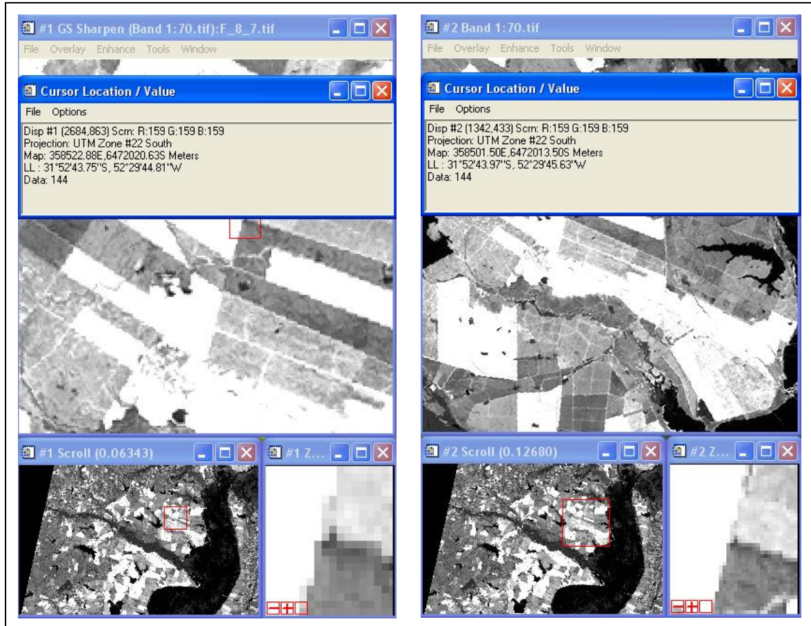
Figura 23 – À esquerda imagem Landsat 7 ETM+ banda 7, à direita imagem Landsat 7 ETM+ banda 7 equalizada.
