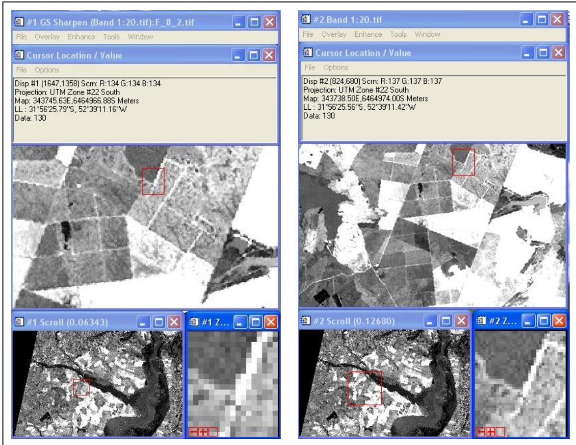
Figura 15 – À esquerda imagem Landsat 7 ETM+ banda 2, à direita imagem Landsat 7 ETM+ banda 2 equalizada.
