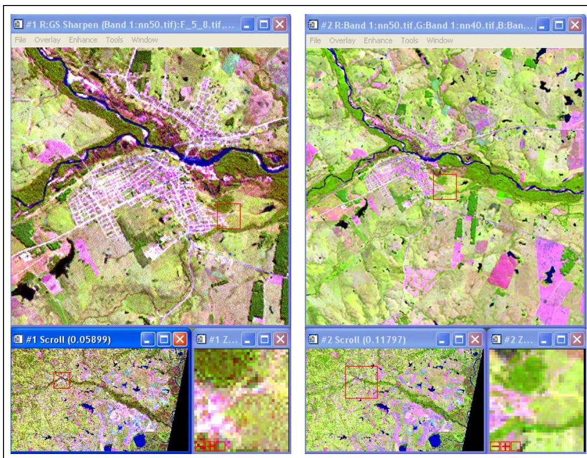
Figura 28 – À esquerda composição Landsat 7 ETM+ bandas 3R8G2B, à direita composição Landsat 7 ETM+ bandas 5R4G3B equalizada.
