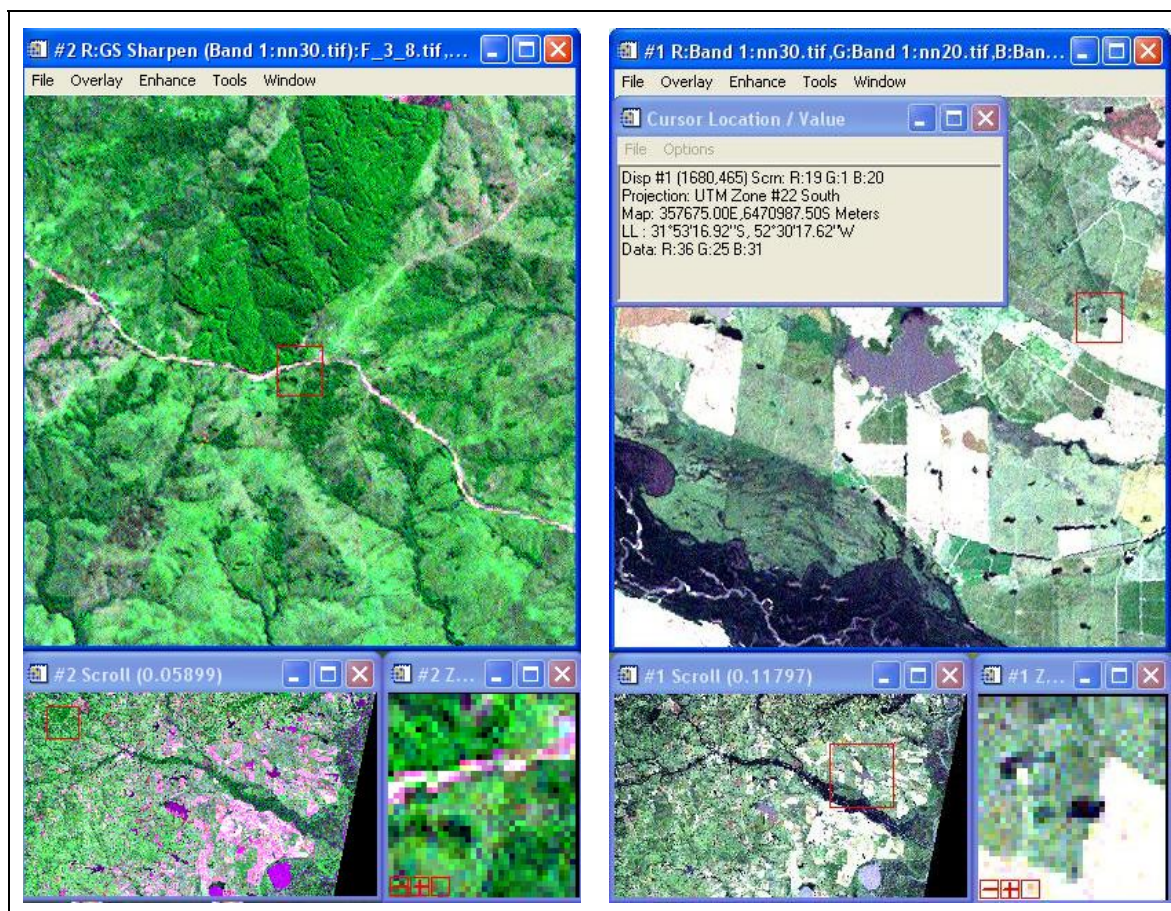
Figura 27 – À esquerda composição Landsat 7 ETM+ bandas 3R8G2B, à direita composição Landsat 7 ETM+ bandas 3R2G1B equalizada.
