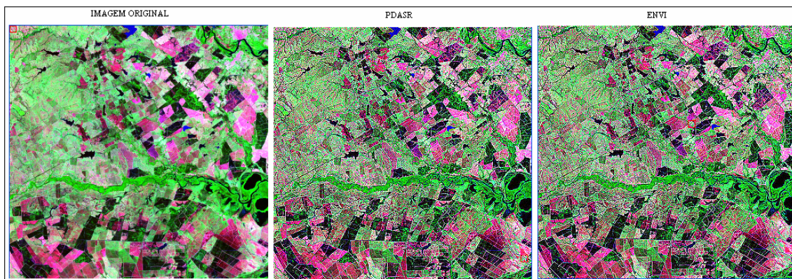
Figura 98 – Imagem original e imagens resultantes da aplicação de um filtro de aguçamento na PDASR e no software ENVI.
