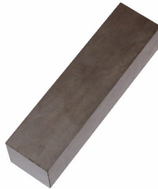
Figura 48 Bloco de Somaloy 500 + 0,5% de Kenolube medindo 30mm x 30mm x 115mm.
