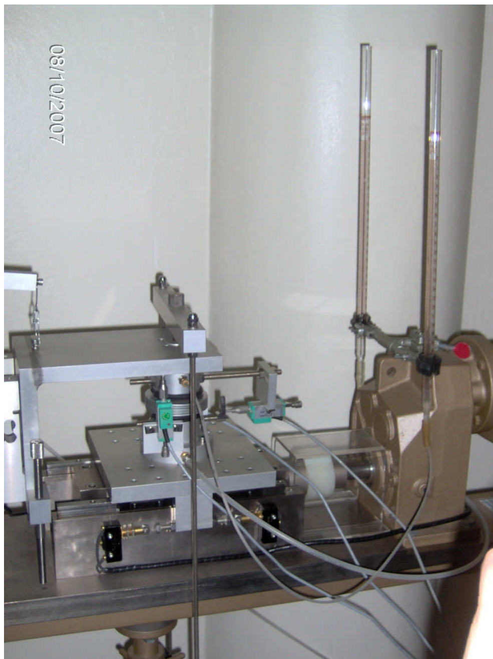
Figura 4.16. Esquema de percolação utilizado nos ensaios inundados.
