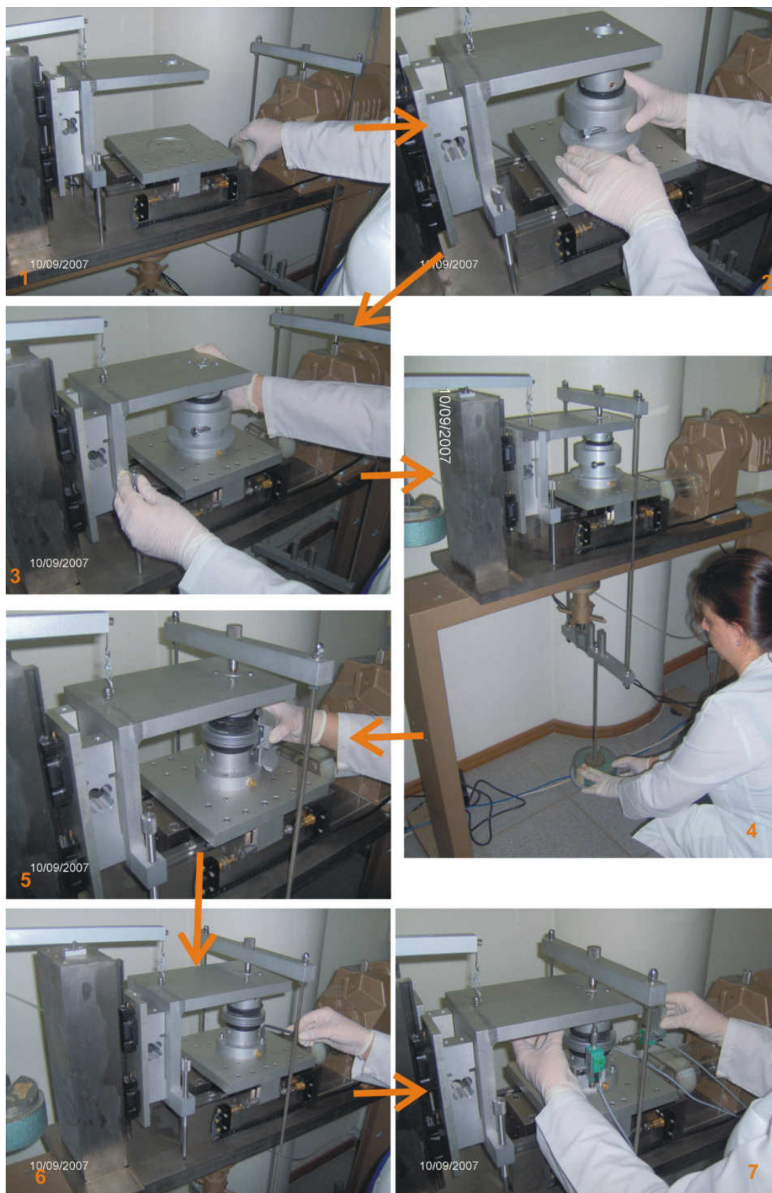
Figura 4.15. Seqüência de montagem dos ensaios da segunda etapa.
