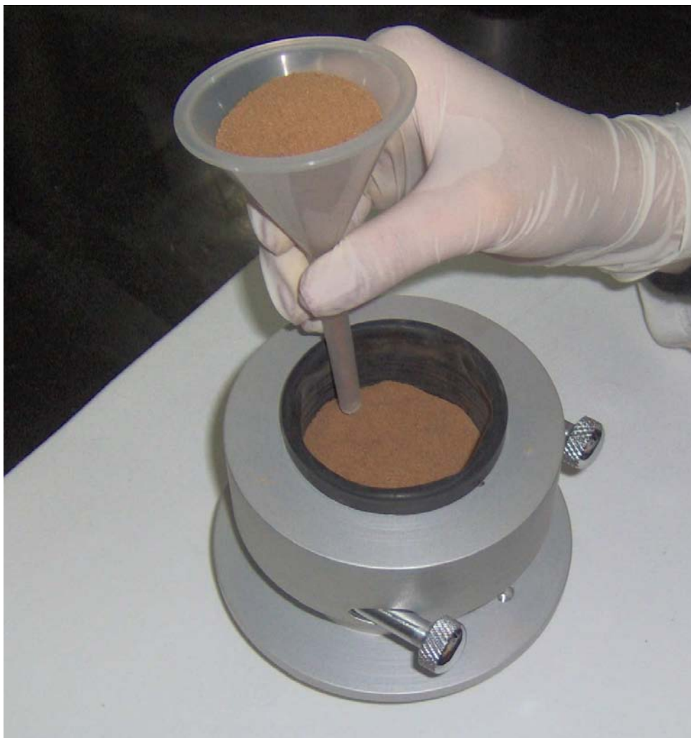
Figura 4.9. Moldagem do corpo de prova de areia escura pelo método do funil.
