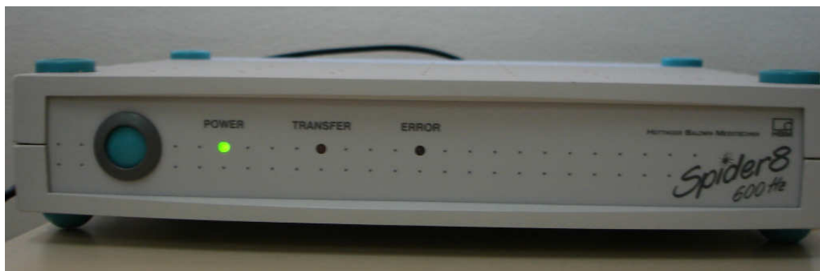
Figura 3.17. Datalogger utilizado (HBM Spider 8).
