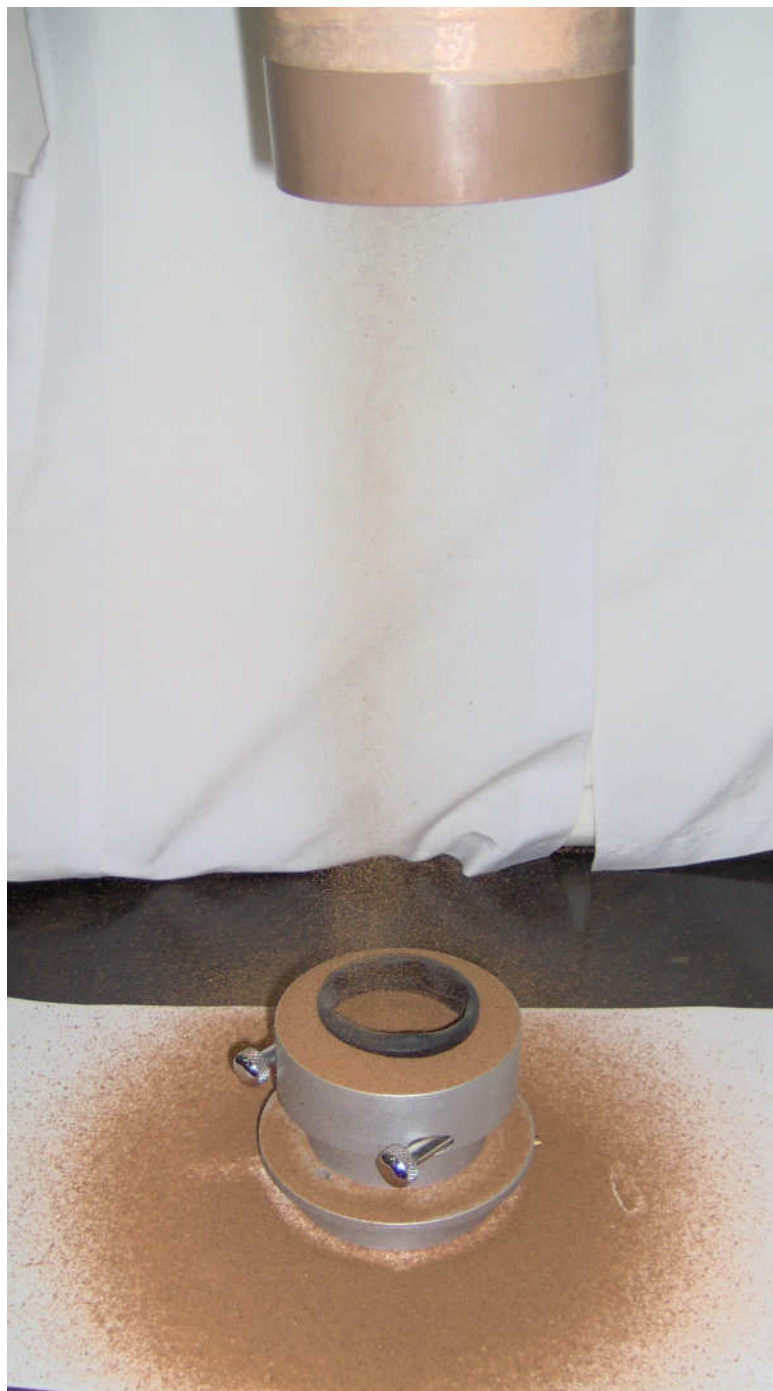
Figura 4.11. Moldagem do corpo de prova de Areia Escura pelo método da pluviação em ar.
