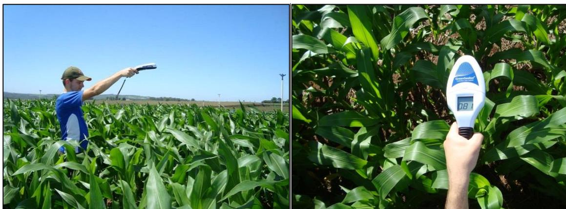
FIGURA 1. Leituras para a obtenção do Índice de vegetação por diferença normalizada (NDVI) com o sensor óptico Greenseeker no estágio fenológico V7 da cultura do milho.
