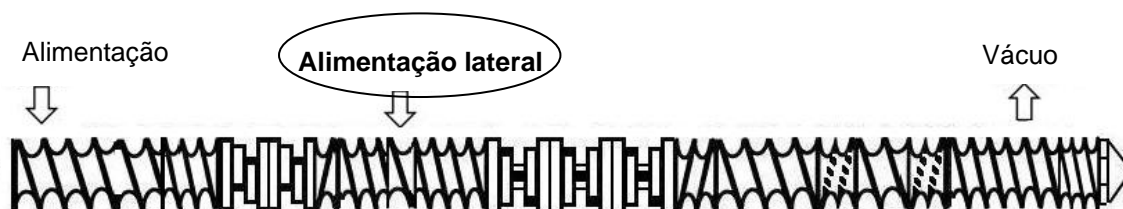
Figura 24. Design da rosca utilizada na preparação dos nanocompósitos. Em destaque, a alimentação da HNT pela alimentação lateral.
