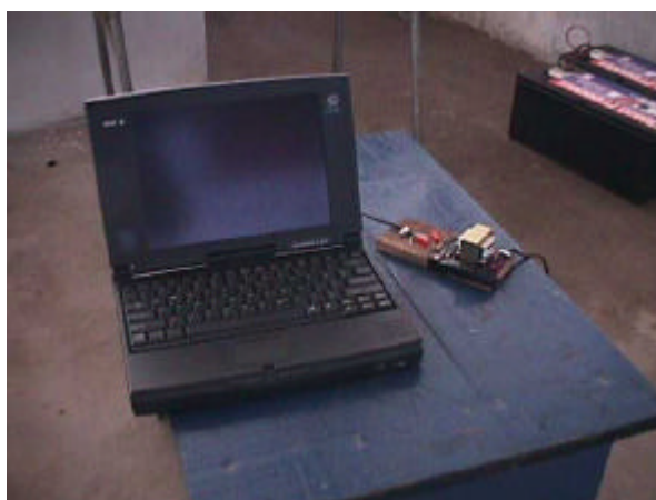
FIGURA 4. 16. Dispositivos utilizados para medição de tensão na bancada do LEH. O laptop tem um processador Pentium de 100MHz, 24MB de memória RAM, 2GB de disco rígido. O adaptador do sinal de tensão consiste de um transformador para rebaixar a tensão de 127V para 12V, e um divisor de tensão, para reduzir o sinal a aproximadamente 400mV.
