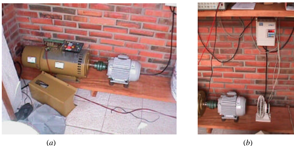
FIGURA 4.4. Vista (a) do gerador síncrono e do motor de indução, e (b) do conversor de frequência e do motor de indução, na bancada do LES.
