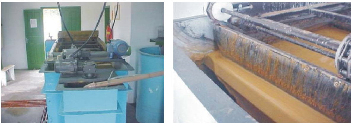
Figura 18 – ETDAM Caixa de Embarque (capacidade para tratar 10 a 20 m 3 .h -1 )
