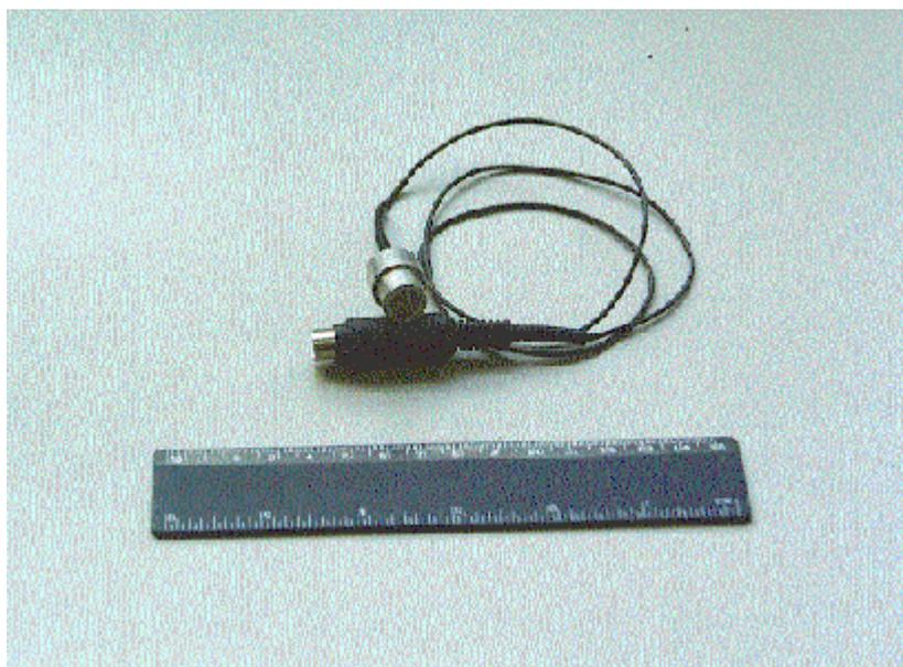
**FIGURA 4.8 – Transdutor de pressão de alta capacidade.**
