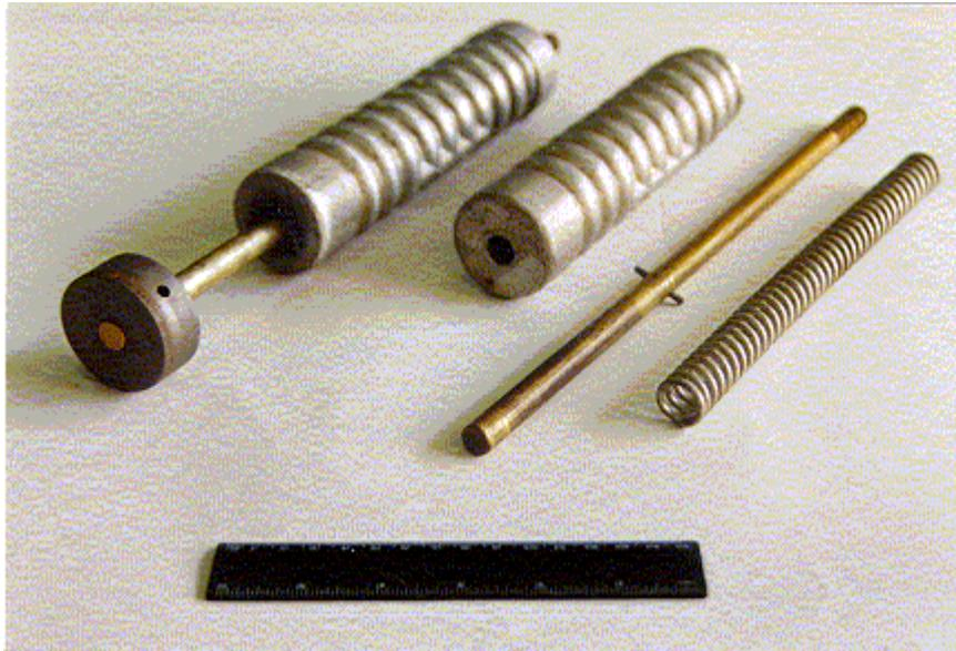
**FIGURA 4.6 – Soquete utilizado na Compactação por Pisoteamento.**
