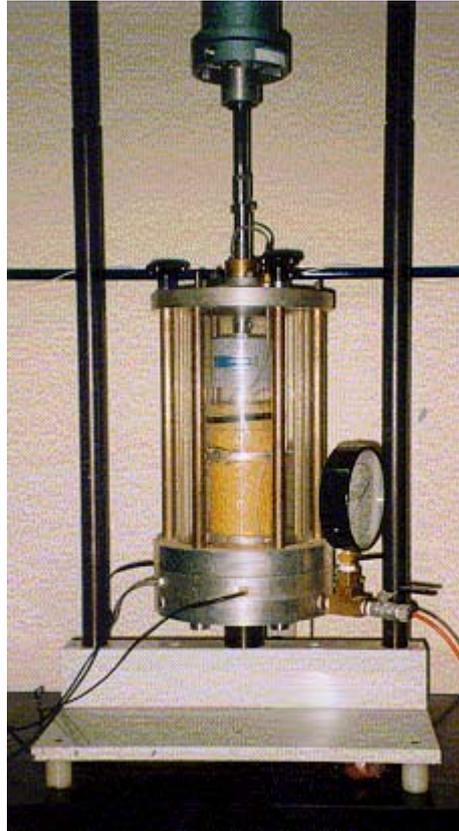
**FIGURA 3.1 - Câmara Triaxial preparada para ensaio de Compressão Triaxial com Carga Repetida.**
