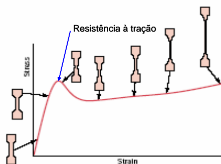
Figura 20 - Comportamento em tração de um polímero semicristalino. (Callister, 2002)
