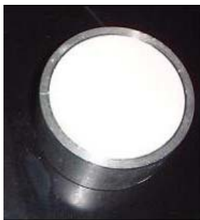
Figura 39 – Pastilha de material pulverizado prensado no anel
