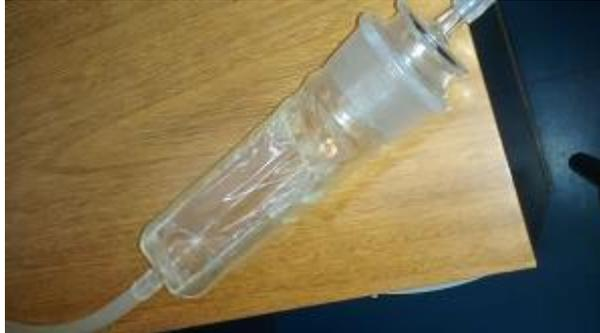
Em caráter experimental, foram realizadas fotólises com amostras de PP em um reator VUV que conta com entrada e saída de gases como representado na FIGURA 8. As amostras foram irradiadas utilizando uma lâmpada Hammatsu de D<sub>2</sub> emitindo a 7,6 eV (163 nm) em presença de N<sub>2</sub> com fluxo constante de 10-20 cm<sup>3</sup>/min em diferentes tempos (0, 15, 30, 60 min). Após a irradiação um fluxo de O<sub>2</sub> foi introduzido para oxidar os radicais formados durante a iluminação VUV.
