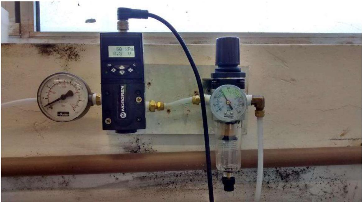
Figura 3.6 – Válvula proporcional utilizada na construção do equipamento *simple shear*
