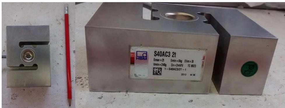
Figura 3.13 – Célula de carga para duas toneladas
