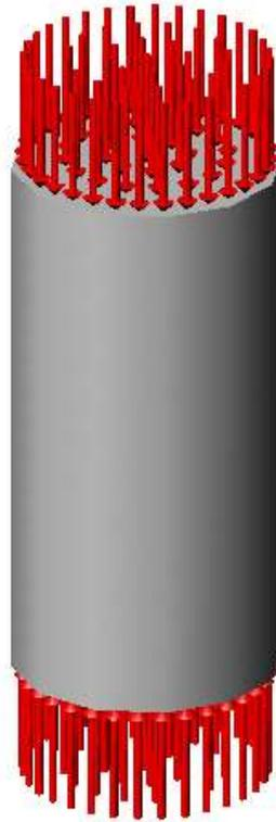
Figura 2.1 – Esquema do ensaio de compressão simples
