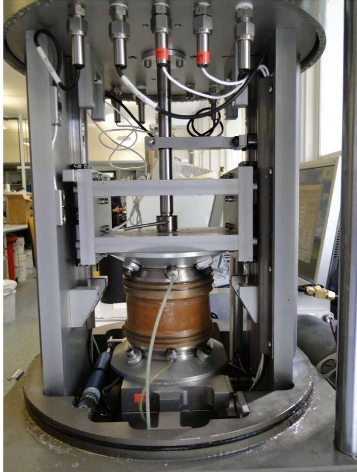
Figura 2.15 – Colocação da amostra no *simple shear* apresentado na UWA (FESTUGATO *et al.*, 2015)
