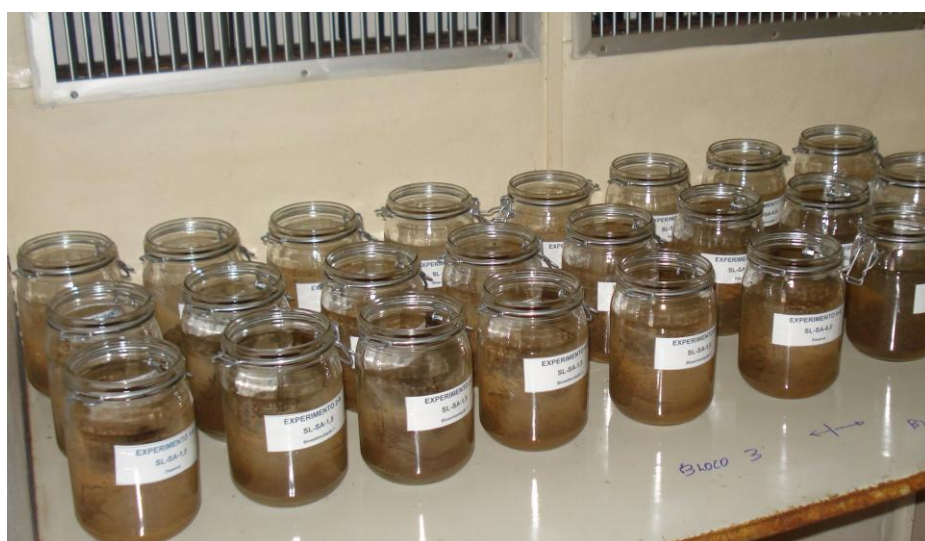
Figura: Aparato experimental utilizado no estudo de biorremediação de solos em sistema aberto
