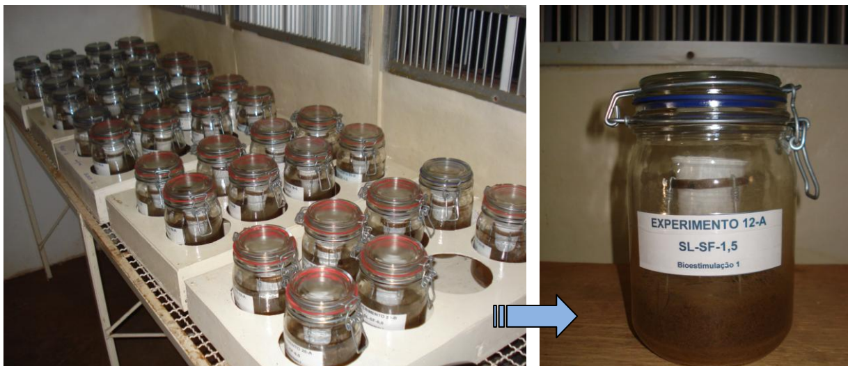
Figura: Aparato experimental utilizado no estudo de biorremediação de solos em sistema fechado
