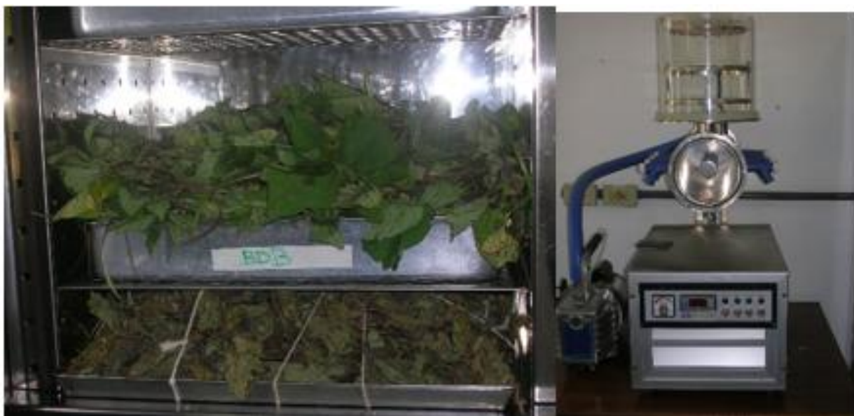
Figura 15 Estufas de secagem com material sendo desidratado e liofilizador usado na preparação de amostras no laboratório de qualidade de alimentos (fonte: autor).
