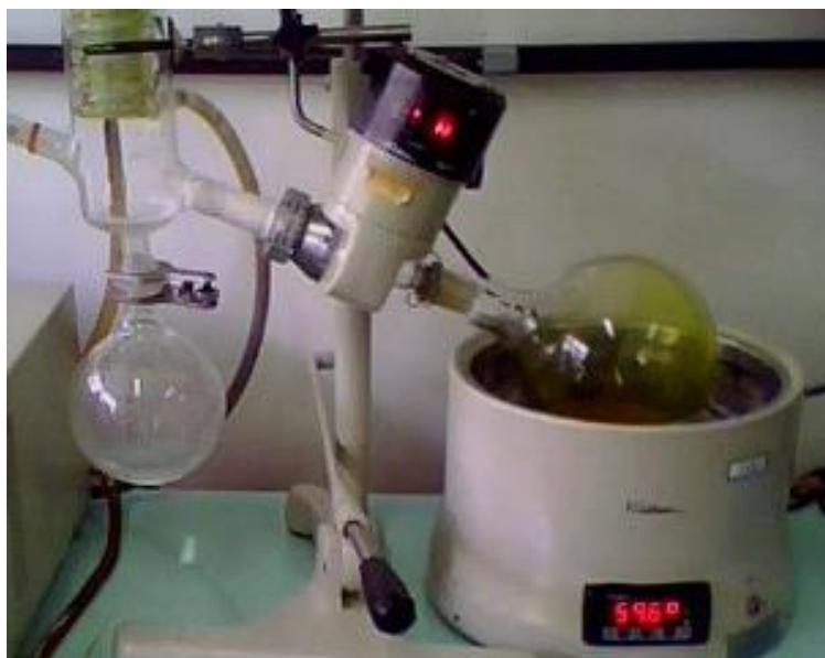
Figura 17 Sistema de rotavapor durante a separação da fase alcoólica após o período de maceração (Fonte: autor)
