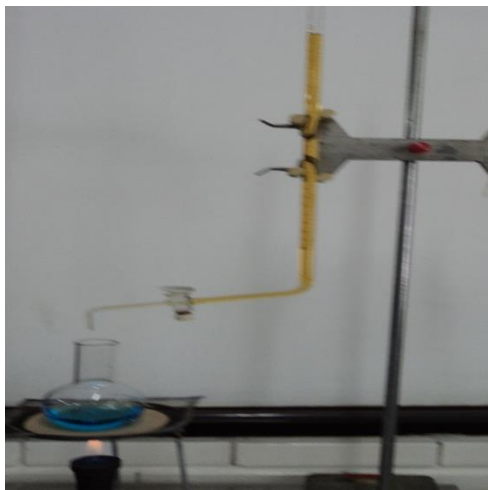
Figura 18 Processo de titulação da solução de Fehling pela amostra para obtenção do volume da amostra gasta na titulação (Fonte: Autor)
