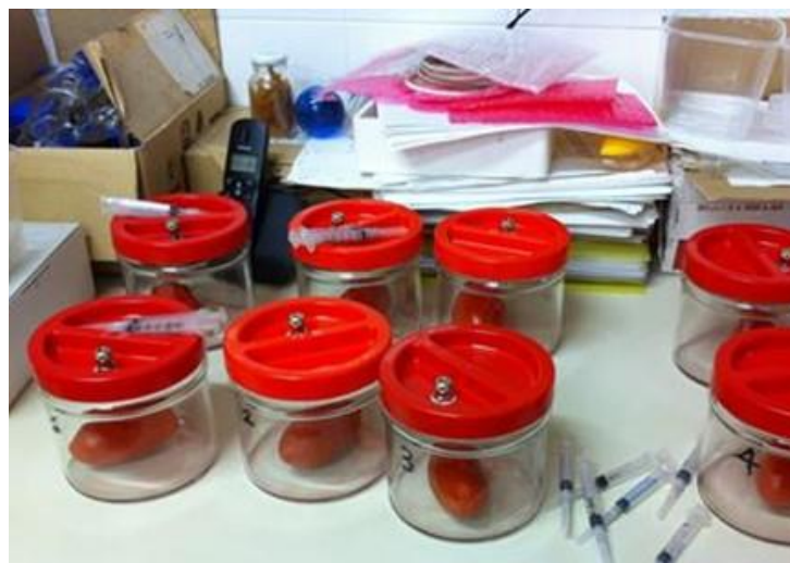
Figura 24 Frutos colocados em jarros herméticos para avaliação da evolução de gás carbônico e etileno
