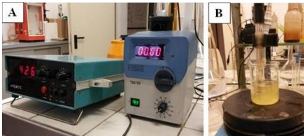
Figura 23 Titulador automático e pHmetro para acompanhar viragem de pH (A) e processo de titulação (B)
