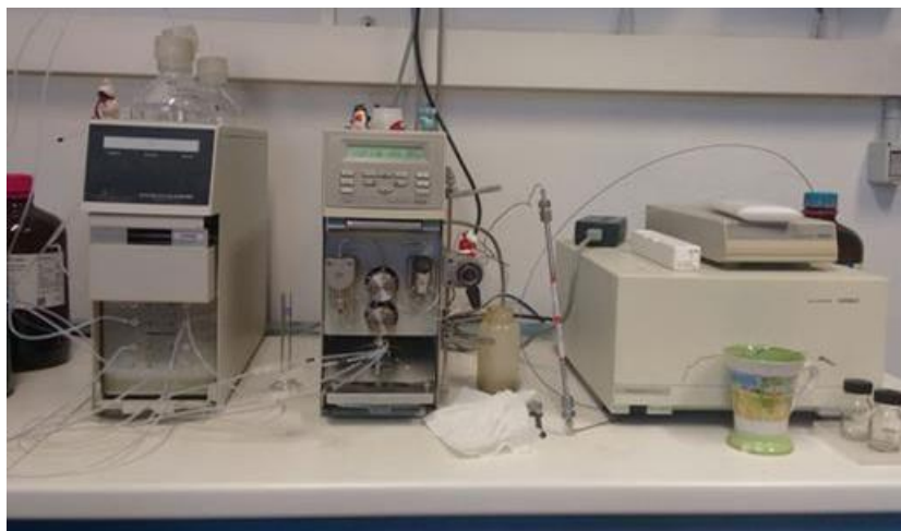
Figura 25 HPLC com detector de arranjo de diodos UV 6000 LP e coluna CL-18 RP
