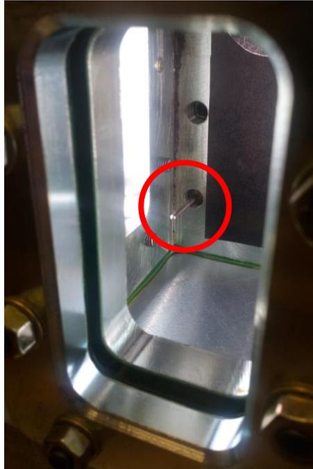
Figura 3.14 – Localização da instalação da termoresistência
