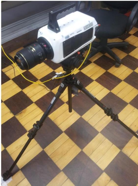
Figura 3.10 – Câmera de alta velocidade com lente acoplada e tripé de fixação
