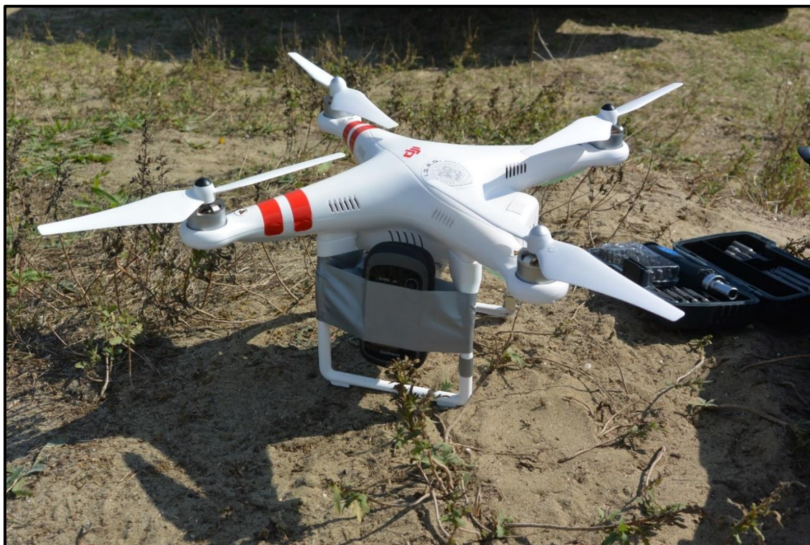
Figura 12: O DJI Phantom 2 com um GNSS eTrex ® 30-Garmin fixado ao VANT para obter um georreferenciamento mais preciso.
