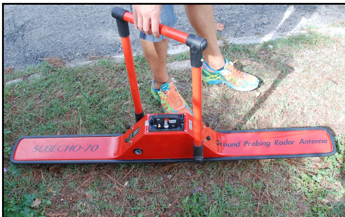
Figura 11: Sistema GPR utilizada para adquirir os dados em subsuperfície na planície costeira de Ravenna.
