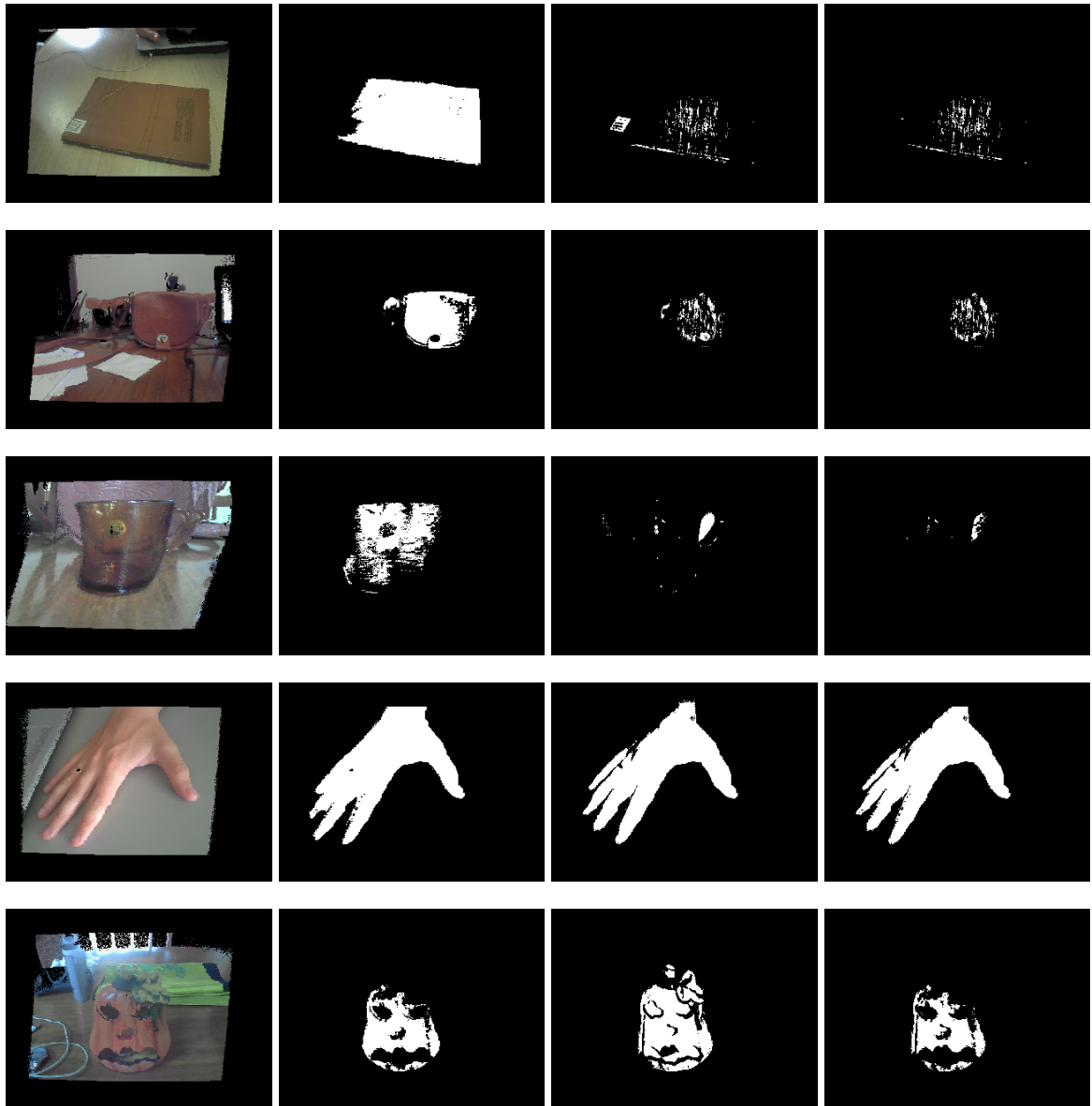
Figura 3.8 – Resultados para o teste de cor dado pela Equação 3.5 e 3.6. Imagens contendo objetos com cor de pele (primeira coluna) segmentadas pela cor de pele (segunda coluna) e pela confiança (terceira coluna). O resultado final da segmentação encontra-se na quarta coluna.
