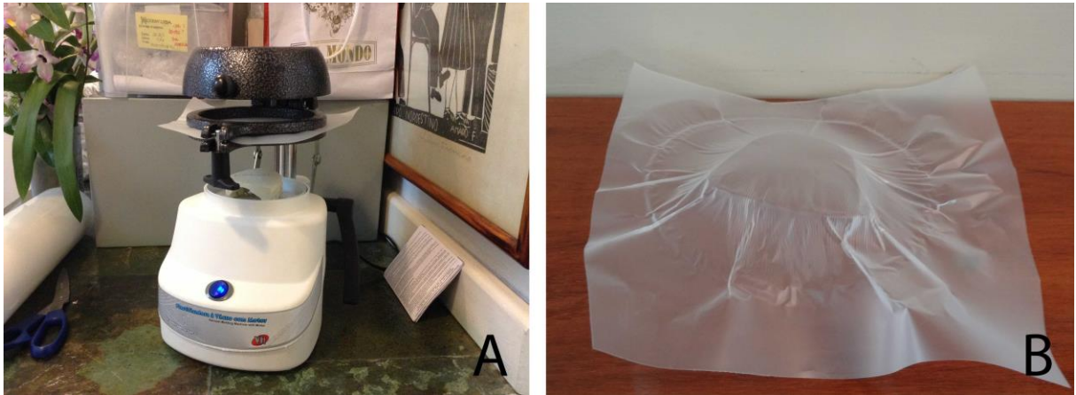
Figura 31 - Teste de termoconformação do material-resíduo.
