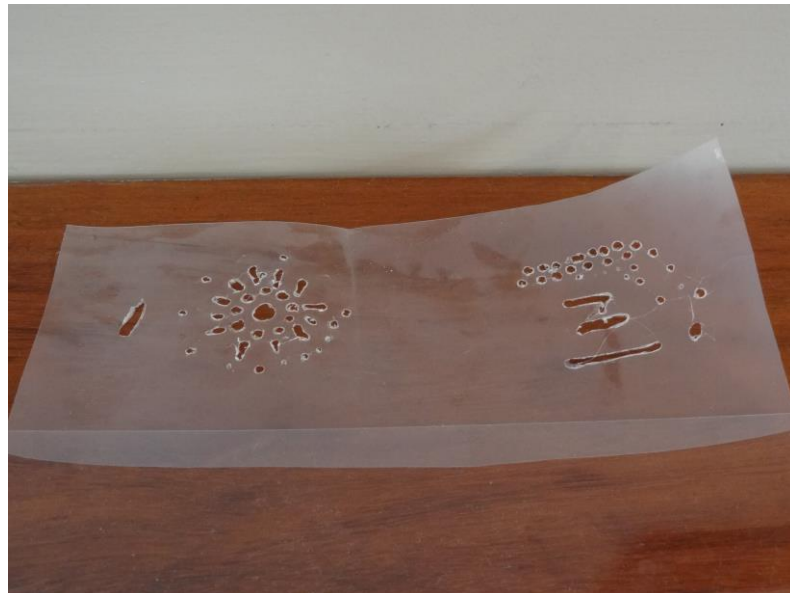
Figura 32 - Teste com um ferro de solda no material-resíduo.
