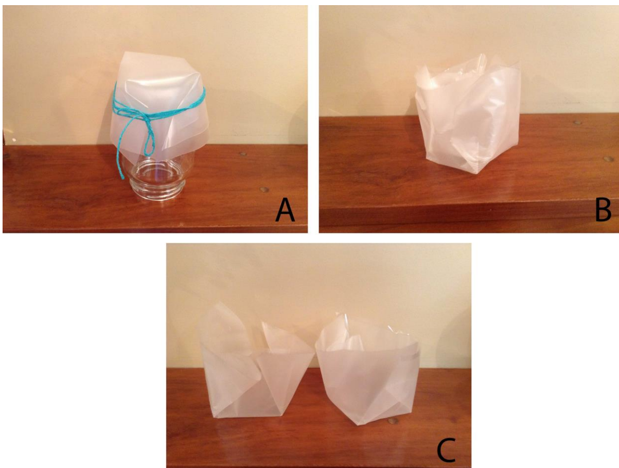
Figura 26 - Experimento forno caseiro 4 – material-resíduo (já laminado) – duas lâminas sobrepostas – 220°C, 5 minutos.
