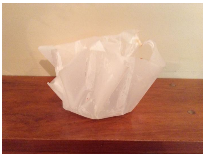
Figura 23 – Resultado do experimento em forno caseiro 1 – folhas de laminação sobrepostas – 180°C por 10 minutos.
