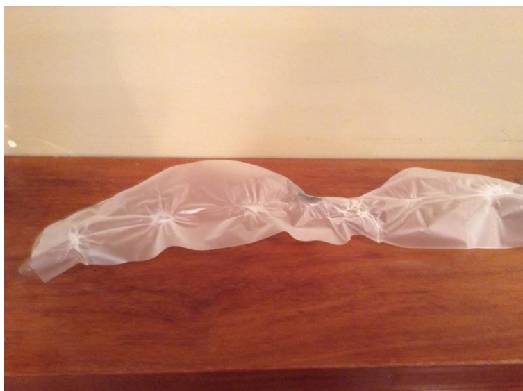
Figura 29 - Experimento fogo – enrugamento da superfície da amostra.
