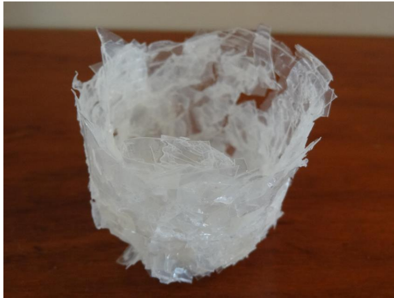
Figura 34 - Teste de material-resíduo com cola branca.
