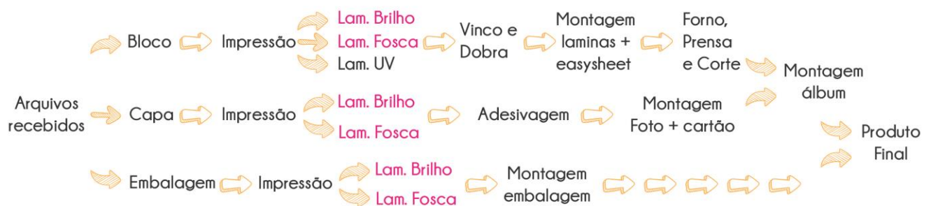
Figura 7 - Esquema do processo de fabricação dos álbuns fotográficos
