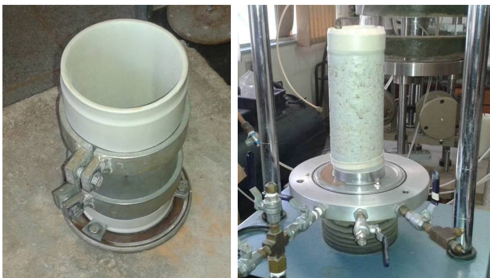
Figura 51: Membrana inserida antes da moldagem do corpo de prova (à esquerda) e após a desmontagem do molde no equipamento para realização do ensaio (à direita).
