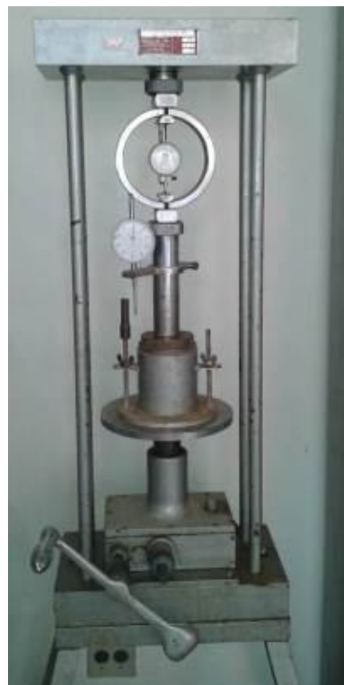
Figura 53: Equipamento utilizado no ensaio de compressão confinada.
