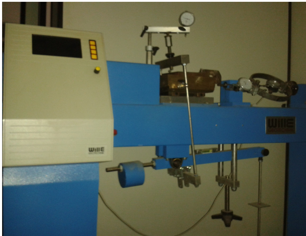
Figura 47: Equipamento utilizado para realização de ensaios de cisalhamento direto.
