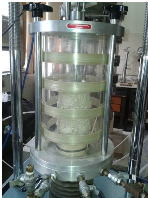
Figura 66: Ensaio triaxial com amostras de multicamadas de material britado e pneus picados.
