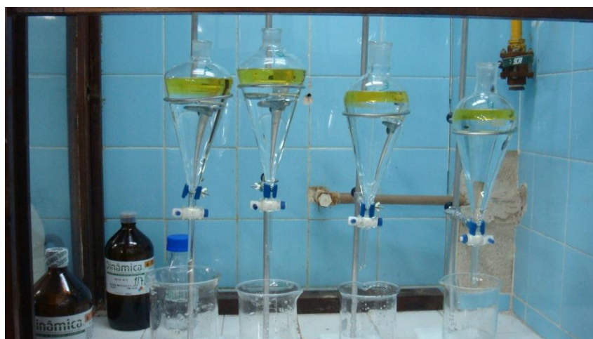
Figura 3.7: Extração dos carotenoides existentes nas microalgas com solventes orgânicos.
