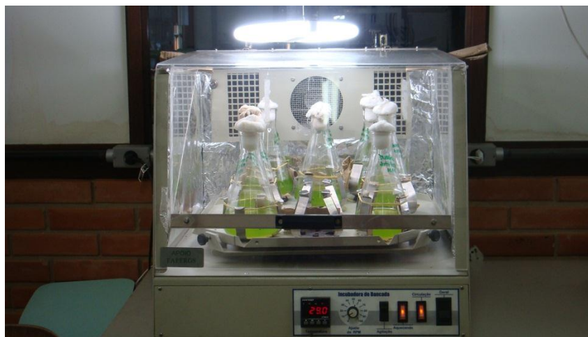
Figura 3.1: Incubadora com agitação orbital utilizada para o preparo dos inóculos.
