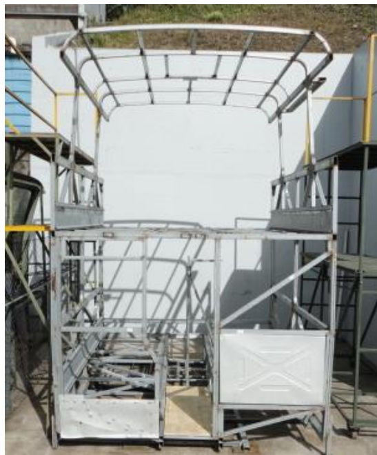
Figura A.14 Seção ou módulo experimental do ônibus de dois andares.
