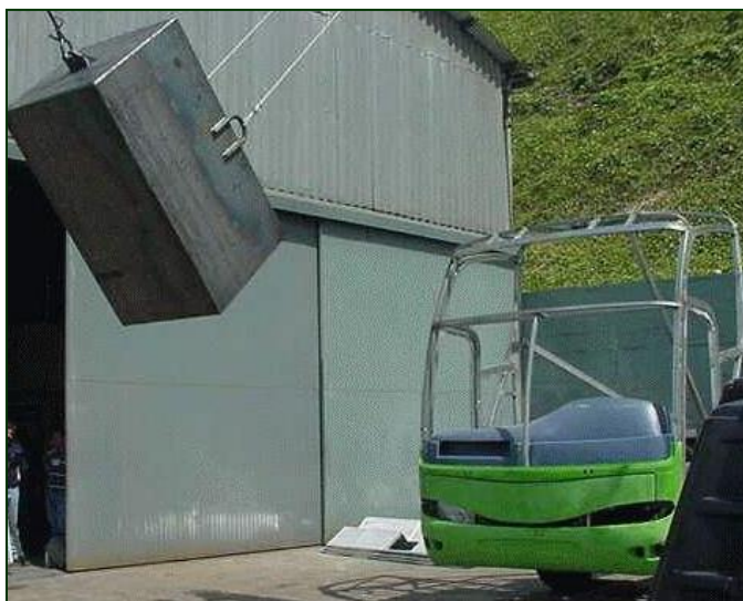
Figura A.15 Teste de impacto frontal.
