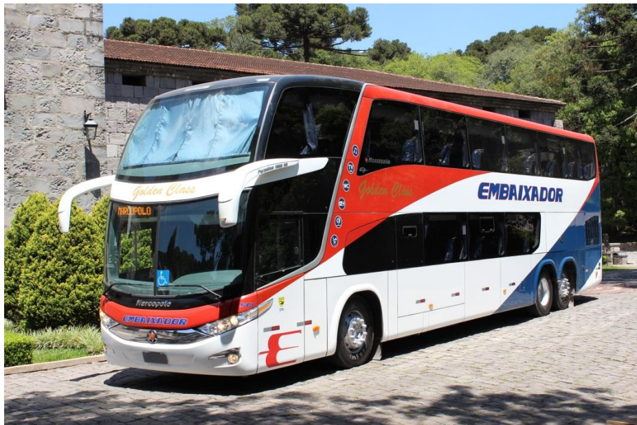
Figura 1.3 Ônibus de dois andares com tração 6x2 e suspensão pneumática.
