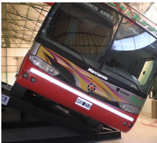
Figura A.12 Modelo de plataforma para ensaio de inclinação lateral na Argentina.
