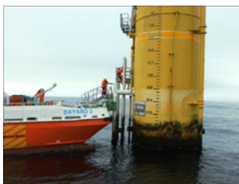
Figura 1.2 – Métodos de aproximação de embarcações em turbinas eólicas [Salzmänn, 2004].
