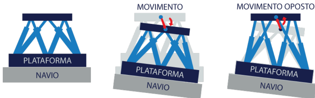
Figura 5.1 – Funcionamento do sistema de compensação de movimentos da maré em um navio. Adaptado de Salzmann, 2004
