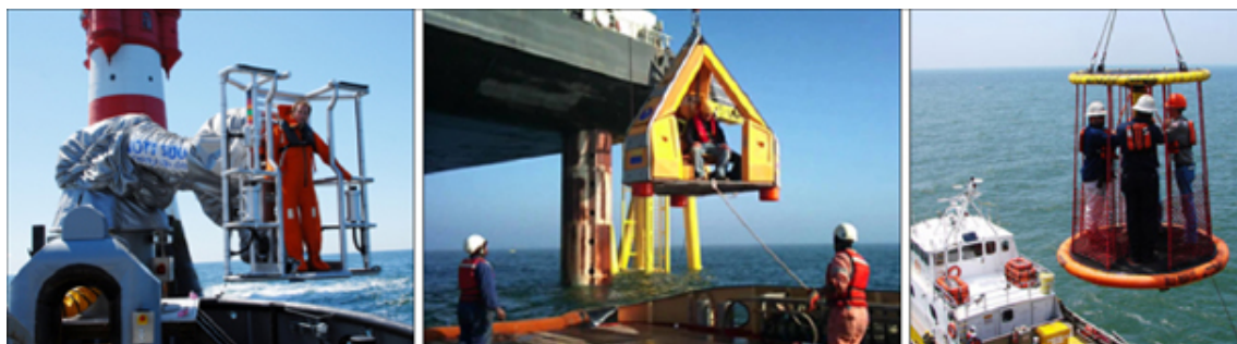
Figura 1.1 – Métodos de embarque e desembarque de estruturas marítimas. a) Braço robótico, b) e c) Guindaste. Adaptado de Leading Group, ReflexMarine e Momac.
