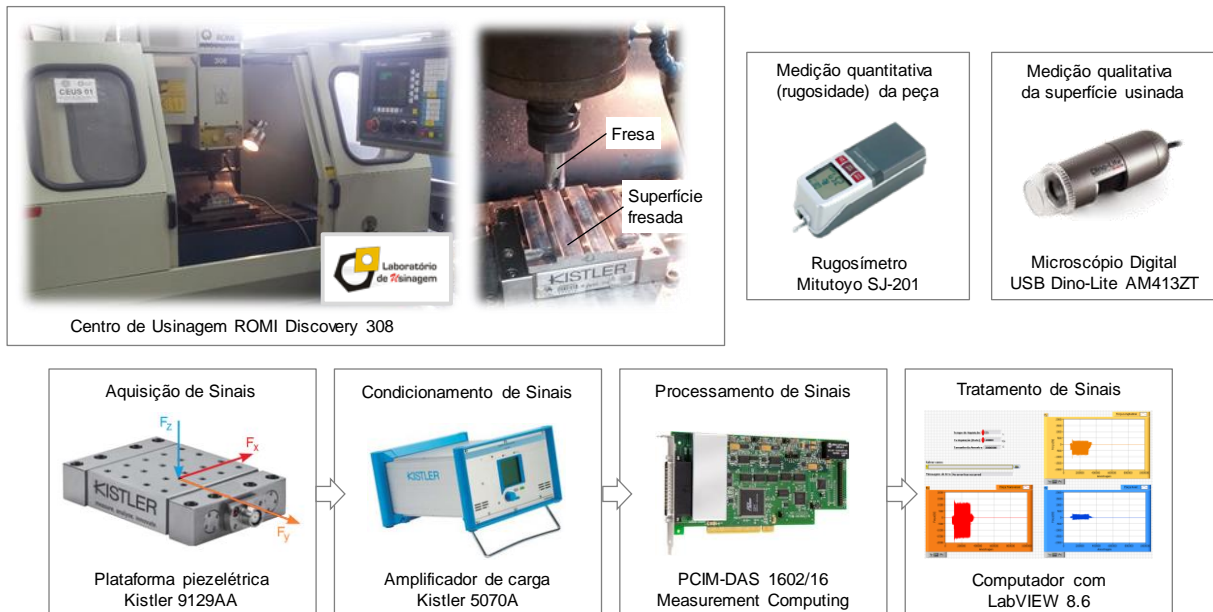
Figura 8.1 – Arquitetura do sistema experimental.
