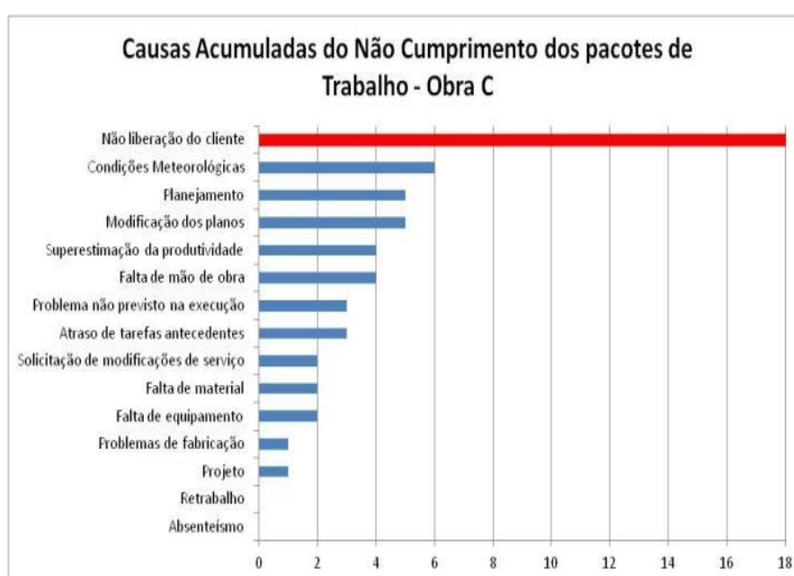
Figura 65: Causas da não conclusão dos pacotes de trabalho – obra C
