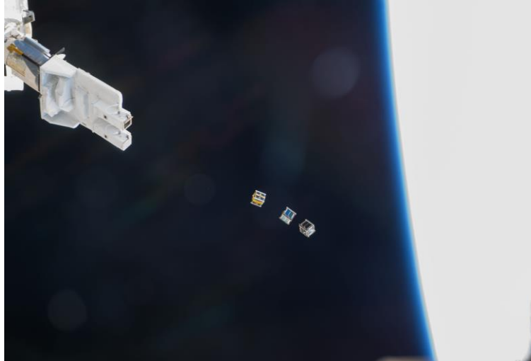
Figura 3.5: Fotografia capturada na Estação Espacial Internacional de três Cubesats sendo ejetados pelo J-SSOD (NATIONAL AERONAUTICS AND SPACE ADMINISTRATION, 2013).
