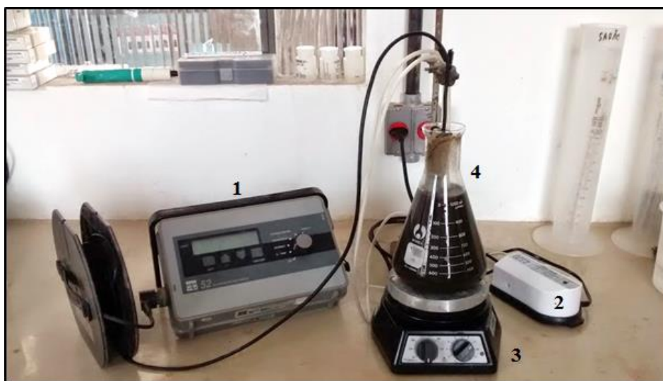
Figura 22 – Equipamento de medida respirométrica, ensaio em execução: (1) Oxímetro modelo YSI 52; (2) Compressor de ar; (3) Agitador magnético; (4) Reator
