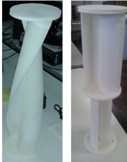
Figura 3.7 – Turbinas helicoidal (esquerda) e duplo-estágio (direita) após serem impressas
