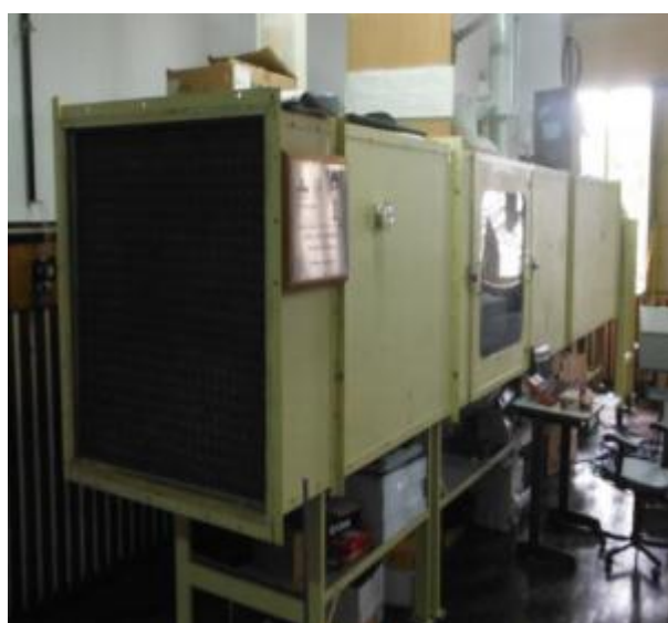
Figura B.1 – Túnel aerodinâmico sem o bocal [adaptado de Luz, 2013]
