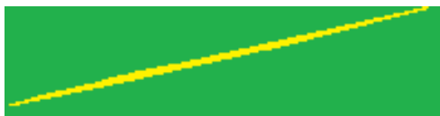
Figura 5-18: TI para modelar barras de areia. Amarelo: areia; verde: argila. Cada pixel representa uma área de 100m x 100m. A barra tem espessura máxima de 300m e cerca de 20km de comprimento.
