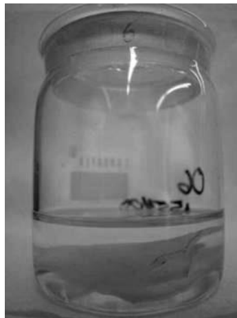
Figura 24. Amostras imersas para avaliação do grau de cura após inchamento em tolueno
