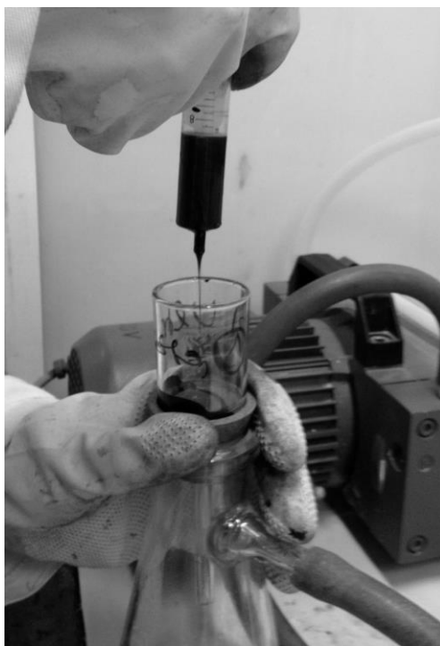
Figura 28. Separação do grafite do óleo por filtragem a vácuo
