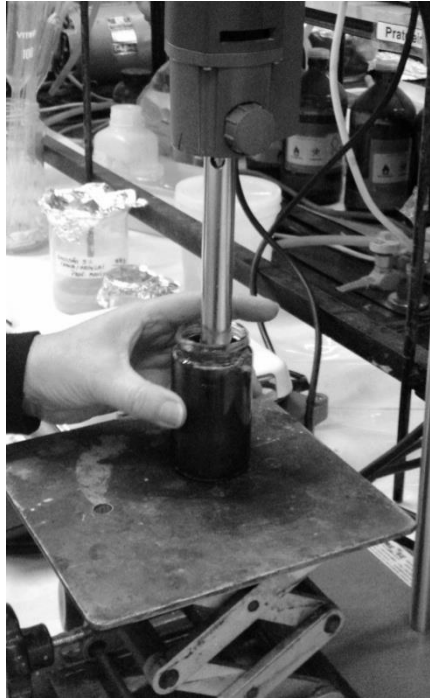
Figura 29. Mistura de DOP/GIOE10 submetida ao cisalhamento no Ultra Turrax
