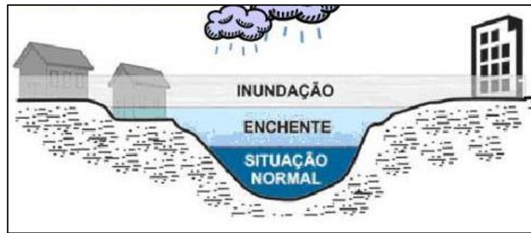
Figura 2.1: Perfil esquemático do processo de enchente e inundação. Fonte: Carvalho, Macedo e Ogura (2007).
